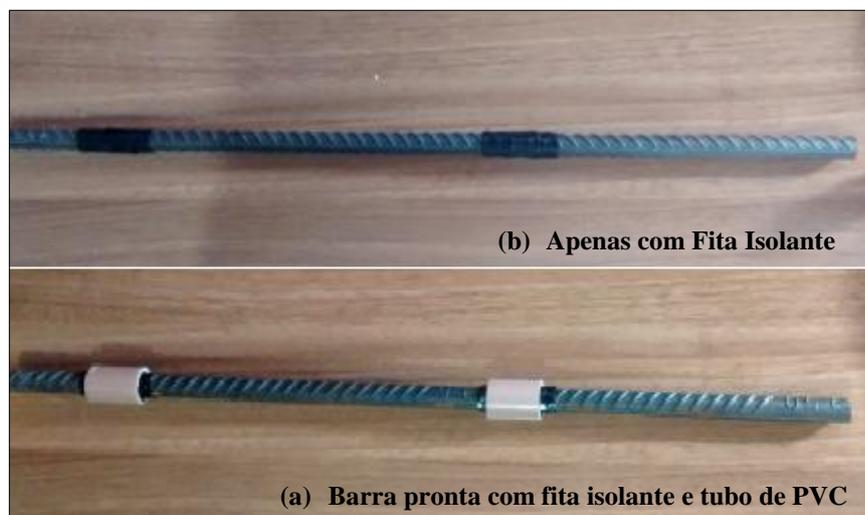
**Figura 14 - Delimitação do comprimento de Aderência**
