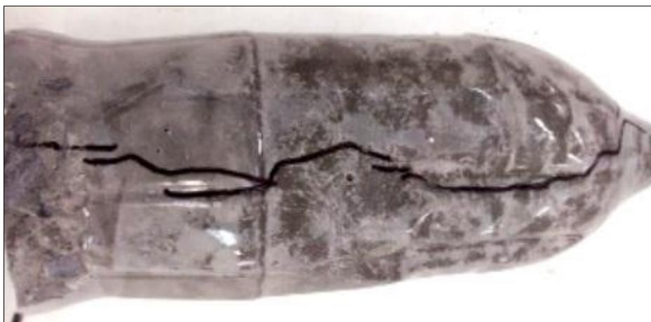
**Figura 22 – Fendilhamento do concreto em virtude dos esforços de tração transversais**
