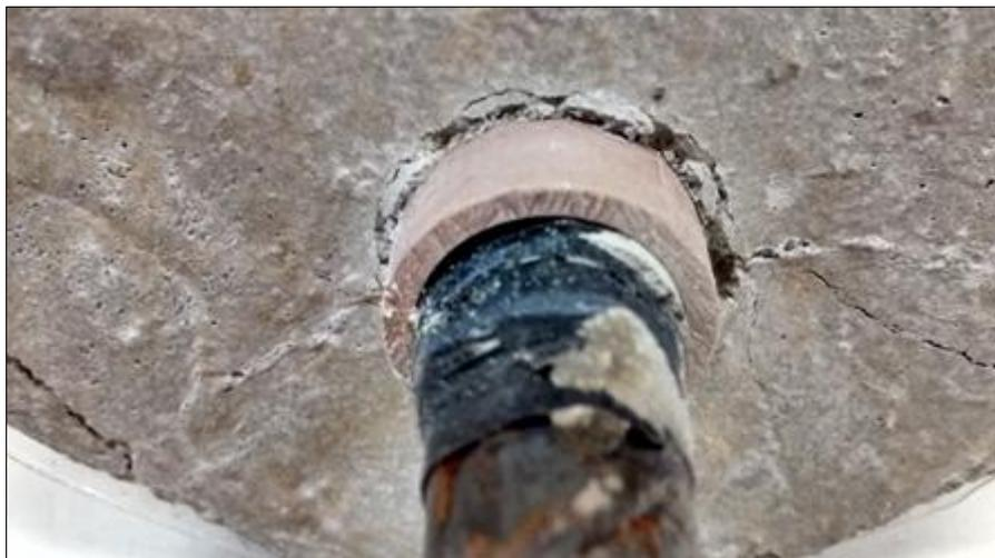
**Figura 20 – Arrancamento da barra de aço pelo fenômeno de deslizamento**
