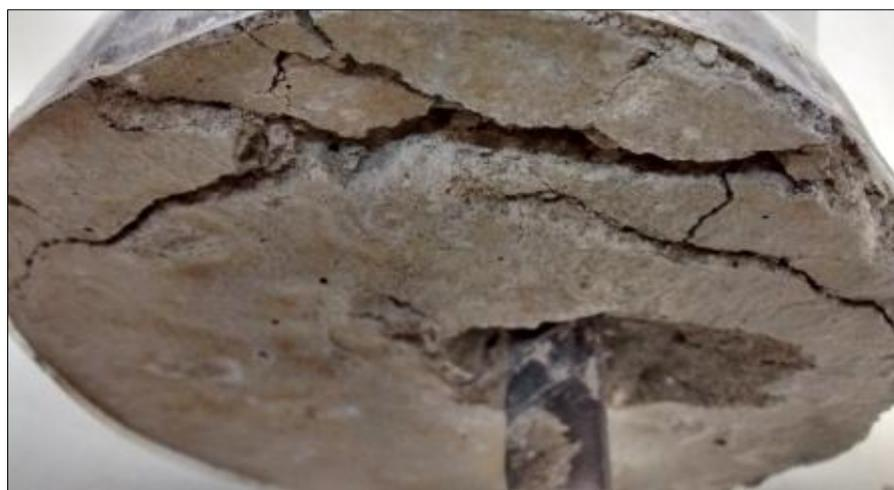
**Figura 21 – Região fissurada do concreto em decorrência da transferência de esforços por aderência**
