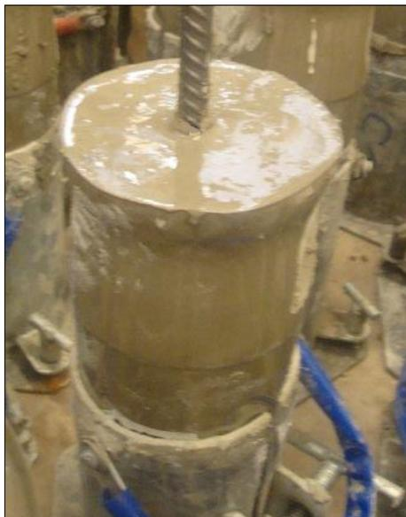
**Figura 16 – Concretagem dos moldes para ensaio Apulot**
