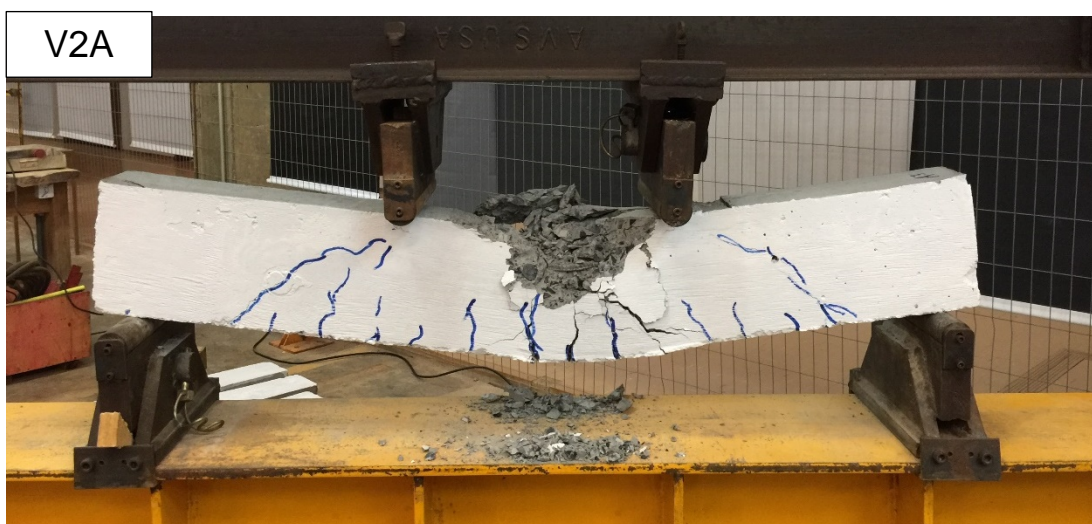
Figura 32: Padrão de fissuração - V2A Fonte: Autoria própria, 2018.
