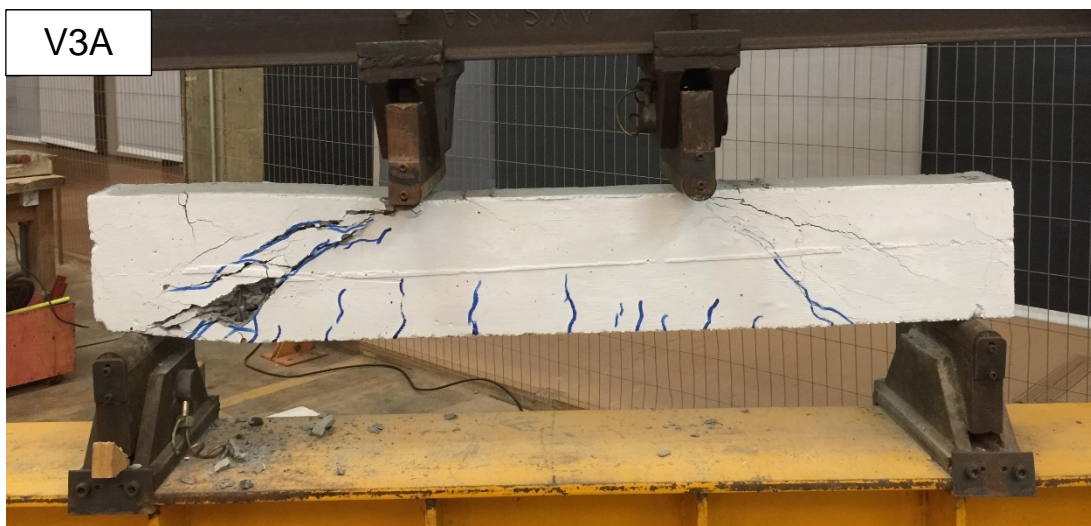
Figura 33: Padrão de fissuração - V3A Fonte: Autoria própria, 2018.
