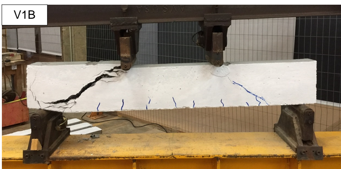
Figura 34: Padrão de fissuração - V1B Fonte: Autoria própria, 2018.
