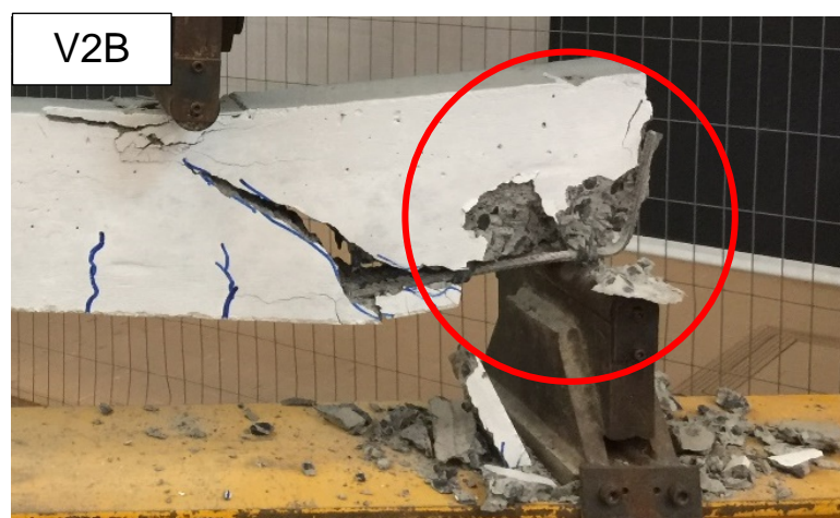
Figura 38: Deslocamento do concreto junto ao apoio Fonte: Aatoria própria, 2018.
