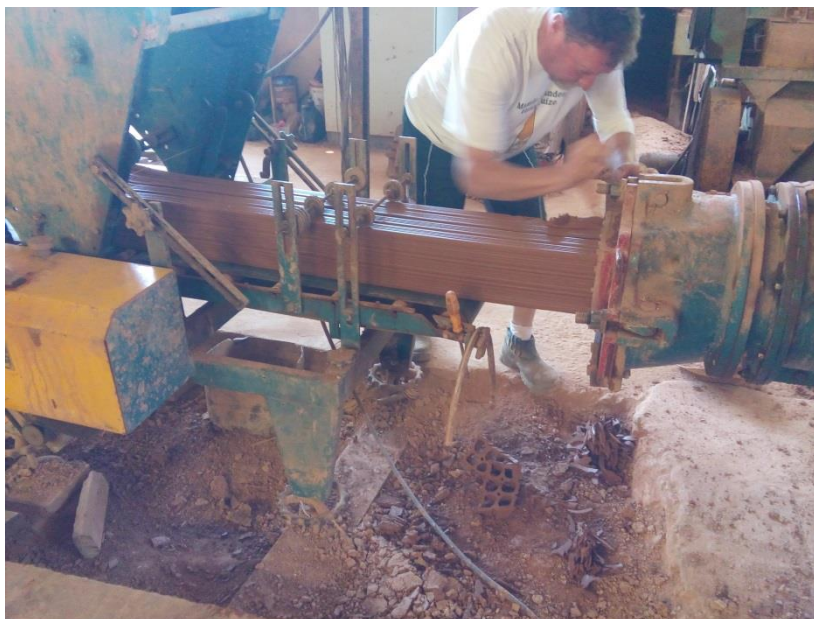
Figura 11 Processo de moldagem dos blocos cerâmicos Fonte: Acervo do Autor (2017)
