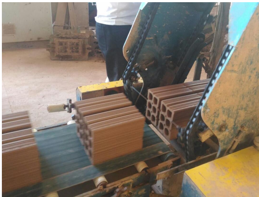
Figura 12 Corte dos blocos cerâmicos Fonte: Acervo do Autor (2017)
