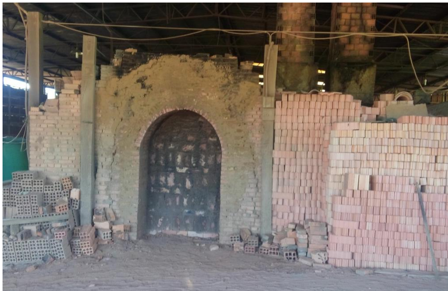
Figura 14 Forno utilizado para queima dos blocos cerâmicos Fonte: Acervo do Autor (2017)
