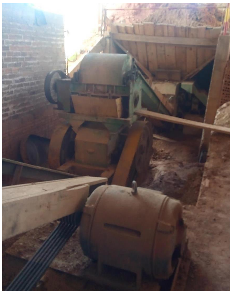
Figura 10 Processo de desintegração, mistura e extrusão Fonte: Acervo do Autor (2017)
