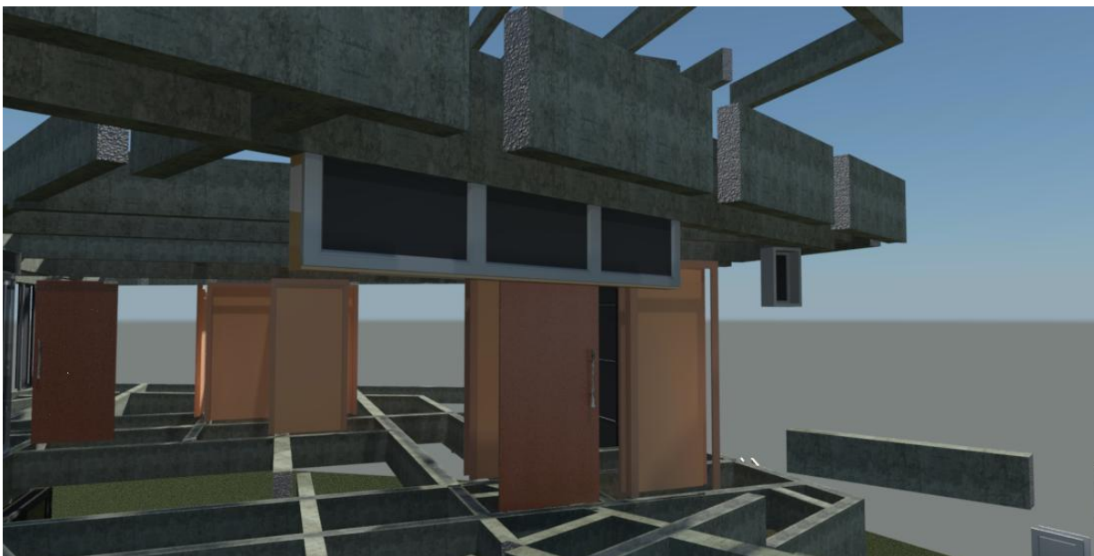
Figura 40 – Conflito entre esquadrias e vigas
