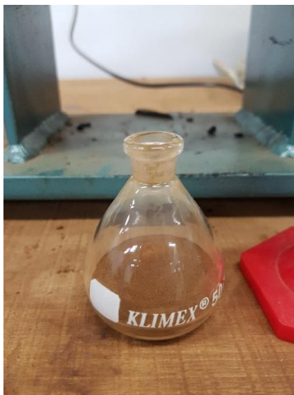
Figura 12-Balão Volumétrico contendo 20g de solo utilizado no ensaio.
