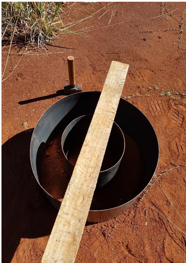
Figura 9-Anéis concêntricos e equipamentos utilizados para inserção.
