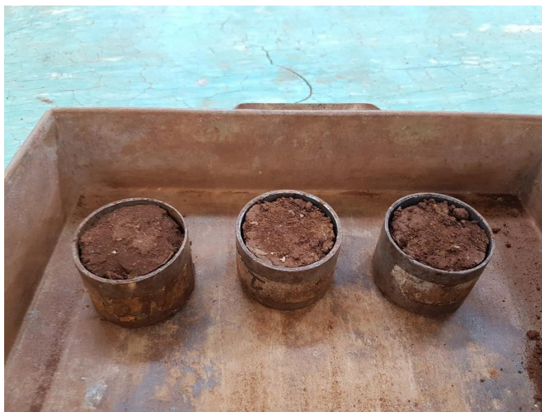
Figura 11-Anéis de Kopeck com solo contido dentro para a determinação do teor de umidade.
