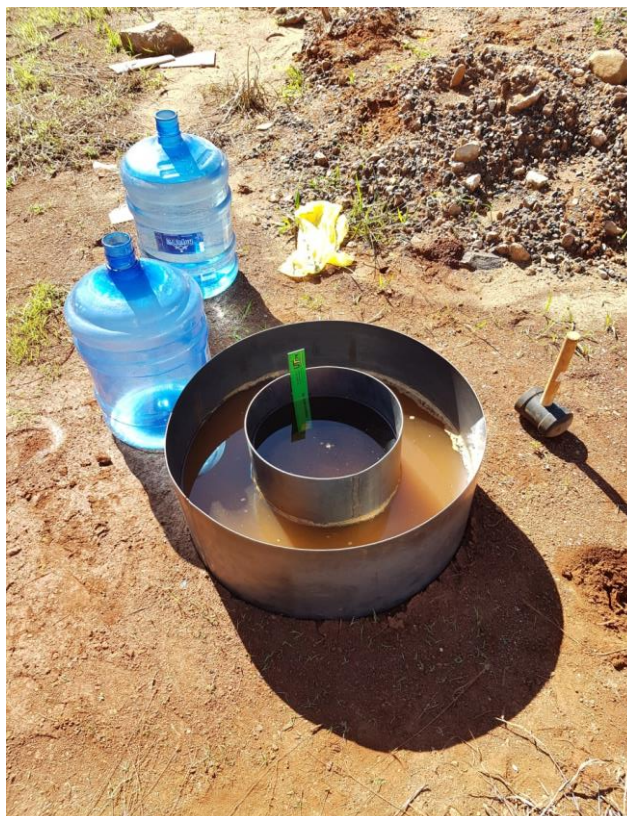
Figura 10-Anéis concêntricos preenchidos com água.
