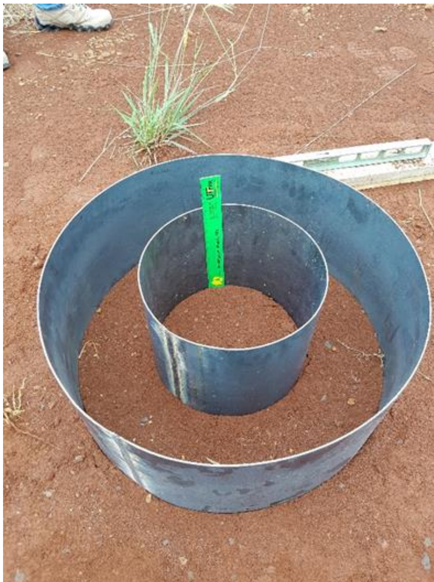
Figura 8- Anéis concêntricos inseridos no solo.
