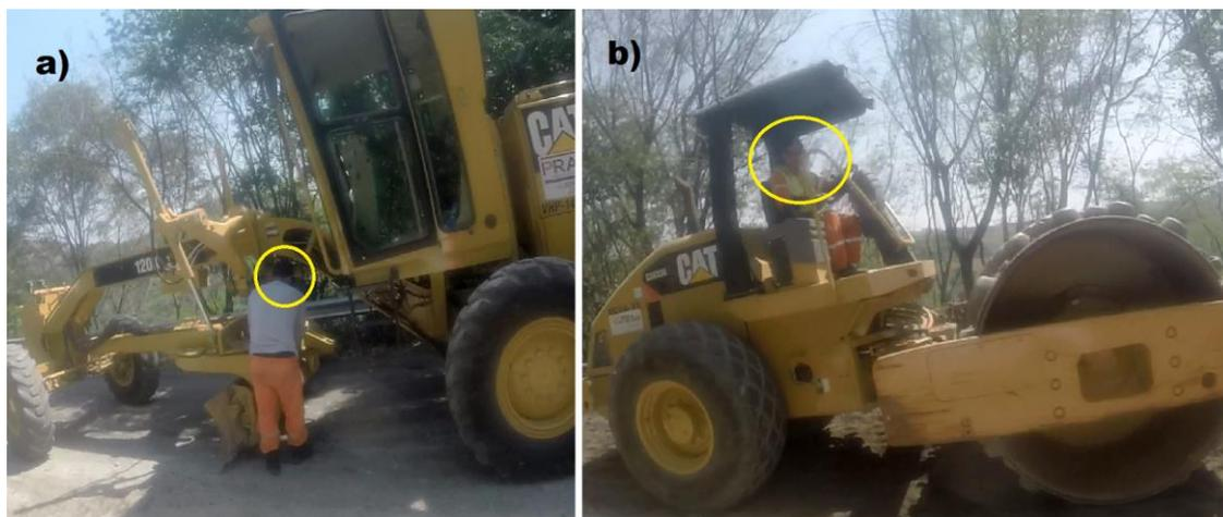
**Figura 21 - a)Operador de Motoniveladora; b)Operador de roo pé de carneiro.**
