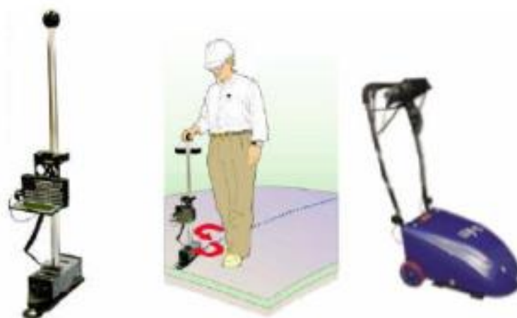
Figura 26 – Dipstick (esq.); Dipstick em uso (centro); e Walking Profiler (dir.). Fontes: Face Companies, 2005; e ARRB Group Ltd, 2005.
