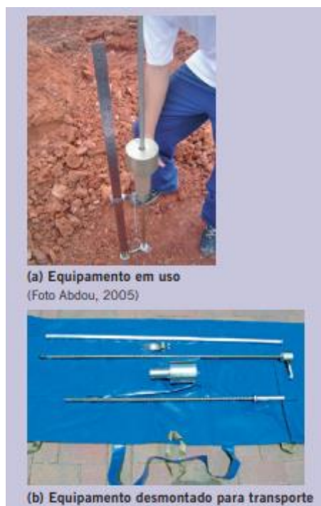
Figura 12 – Exemplo de equipamentos DCP de avaliação estrutural expedita de subsolos e camadas de solo Fonte: Bernucci et al. , 2008.
