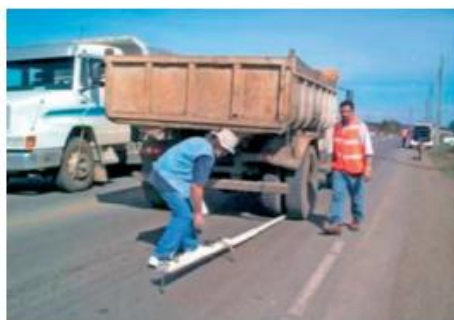
(b) Medida com viga Benkelman em campo
