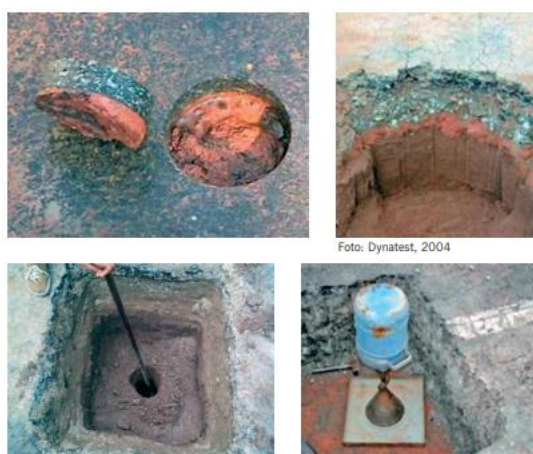
Figura 11 – Extração de corpos de prova e de poços de sondagem Fonte: Bernucci et al. , 2008.
