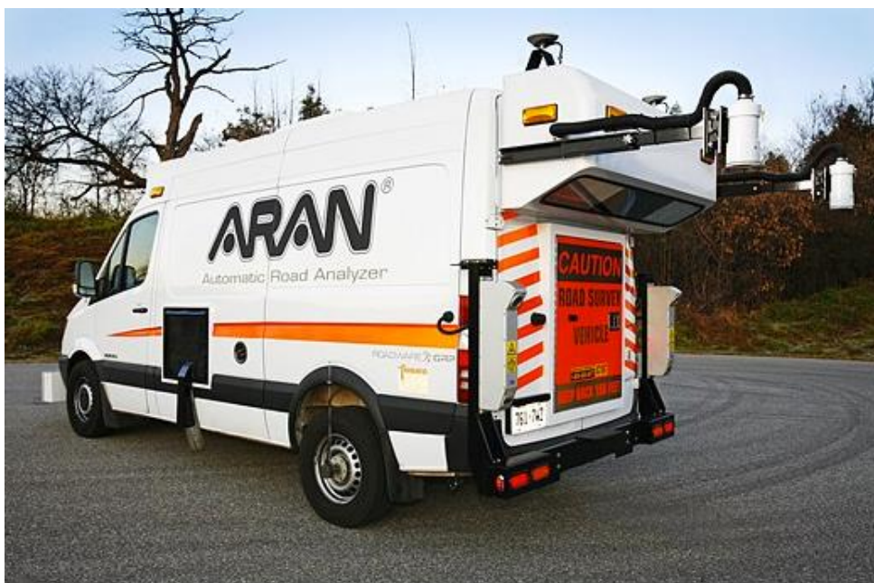
Figura 33 – ARAN – Automatic Road Analyser (Analisador automático de rodovias) Fonte: Higgins, 2011.
