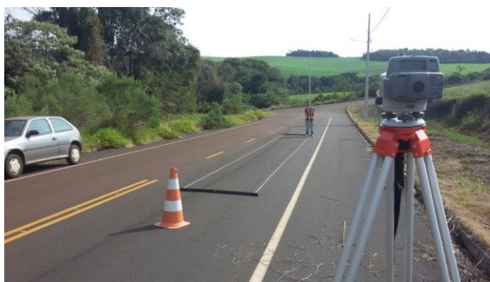
Figura 35 – Levantamento topográfico com auxílio do gabarito confeccionado Fonte: Própria, 2018.
