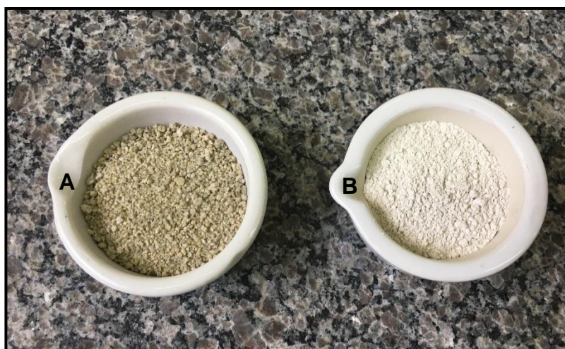
Figura 12 - Escória a ser utilizada nesse trabalho (a) antes e (b) após ser moída. Fonte: Autoria Própria (2017).
