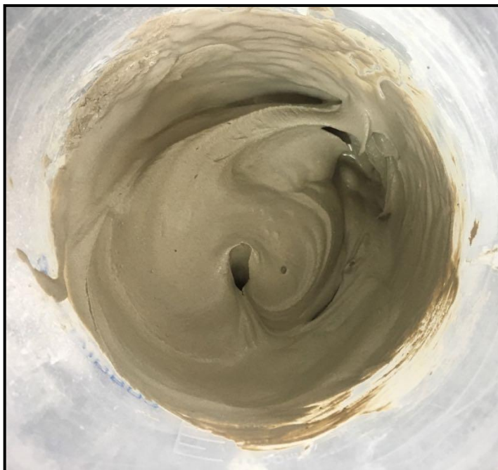
Figura 16 - Pasta de cimento pronta para ser colocada nos moldes. Fonte: Aatoria própria (2018).
