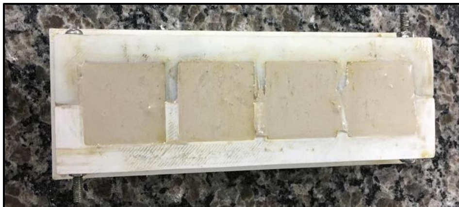
Figura 18 - Moldes com a pasta de cimento. Fonte: Aatoria Própria (2018).
