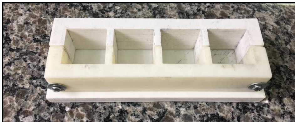
Figura 17 - Moldes utilizados no ensaio de resistência à compressão das pastas. Fonte: Aatoria Própria (2017).
