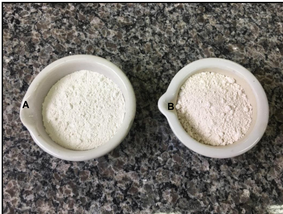
Figura 14 - Gipsita utilizada nesse trabalho (a) natural e (b) calcinada. Fonte: Autoria Própria (2017).
