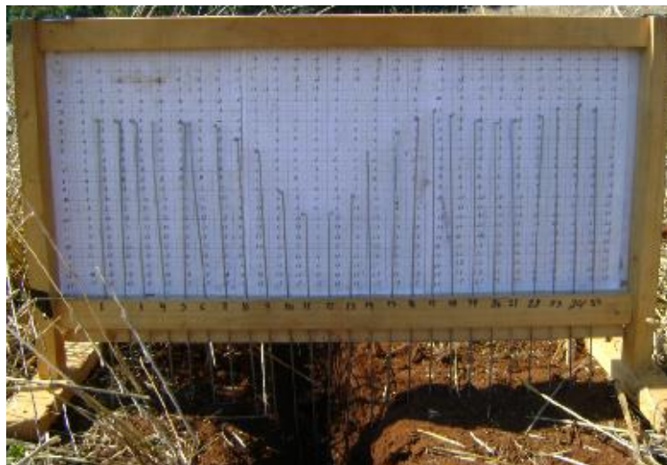
Figura 2. Perfilômetro utilizado para determinação da largura, área e volume de solo mobilizado.
