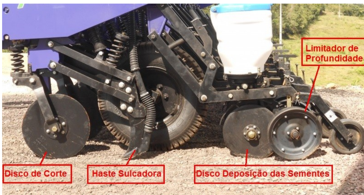
Figura 1: Componentes de uma semeadora-adubadora para plantio direto Fonte - Agriculte (2015), adaptado pelo autor
