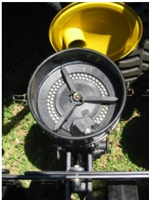
Figura 2: Disco de distribuição de semente horizontal com mecanismo dosador de sementes.
