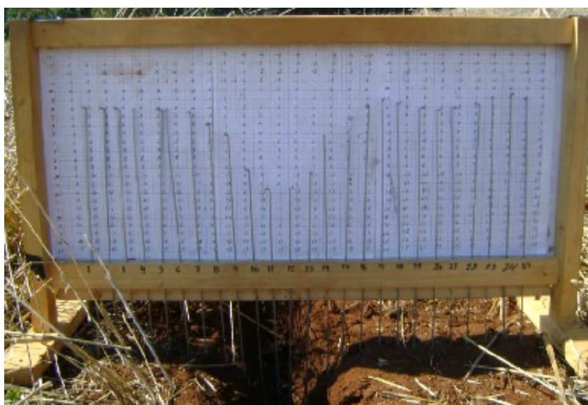
Figura 10: Perfilômetro utilizado para determinação da profundidade de sulco e área de solo mobilizado.
