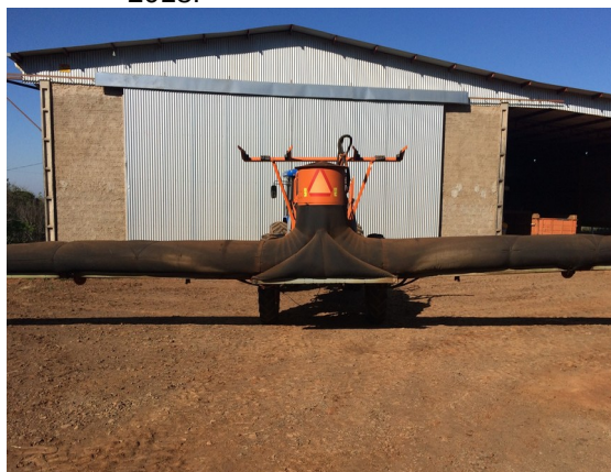
Barra ventilada (Vortex)
