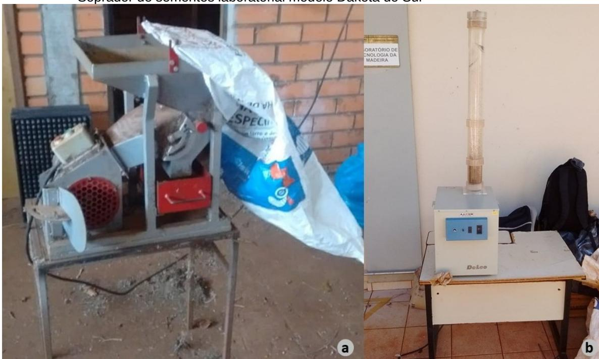
(a) Ventilador industrial de sementes utilizado na pré limpeza das sementes de papuã; (b) Soprador de sementes laboratorial modelo Dakota do Sul
