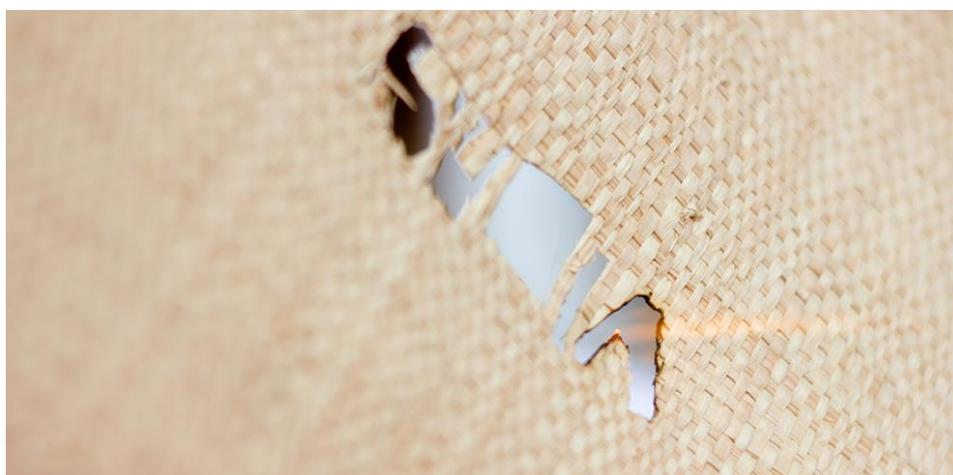
Figura 10 - Fibra de buriti recortada sendo queimada
