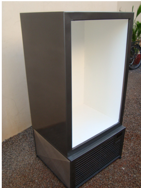
Figura 16: Estrutura superior montada sobre a base inferior.
