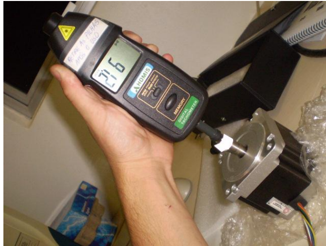
Figura 23 - Medindo a Velocidade com o Tacômetro
