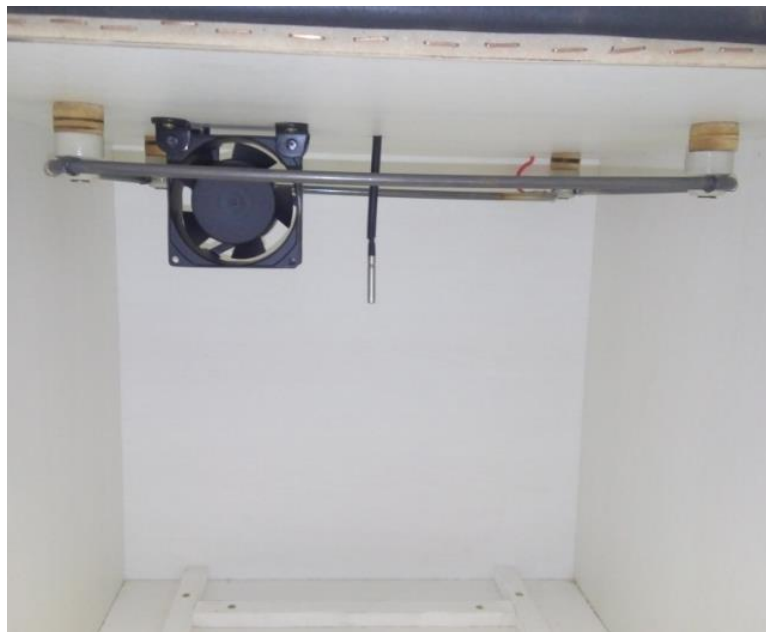
Figura 28 - Vista interna da estufa com resistência elétrica, sensor e ventilador
