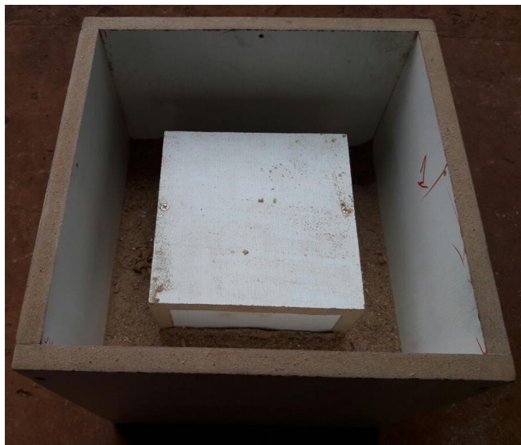
Figura 20 - Vista superior do corpo de prova sendo preenchido com serragem
