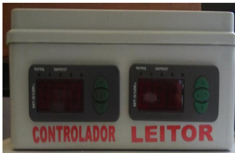
Figura 25 - Vista frontal da caixa de distribuição com o controlador e leitor de temperatura fixados
