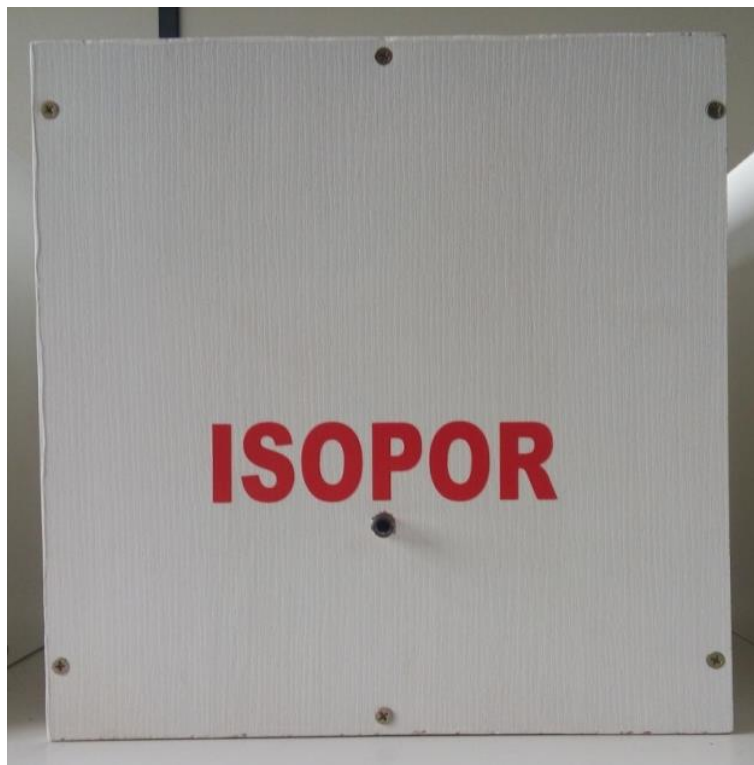
Figura 19 - Vista frontal do corpo de prova com isolamento em isopor com furo para entrada do sensor de temperatura
