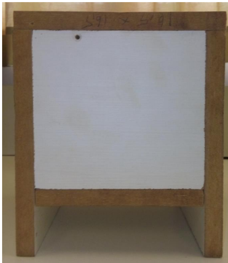
Figura 18 - Caixa interna do corpo de prova
