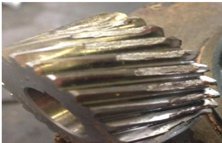
Figura 5 Falha por quebra ou fadiga do material Fonte: Autor
