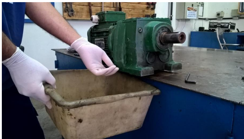
Figura 16 Retirando parafuso de dreno da caixa redutora. Fonte: Autor
