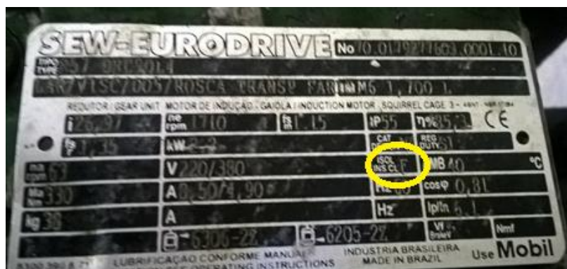
Figura 05 Indicação da classe de temperatura na placa de identificação. Fonte; Autor.
