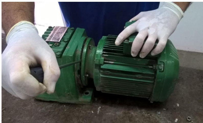
Figura 17 Separando o motor da caixa redutora. Fonte: Autor
