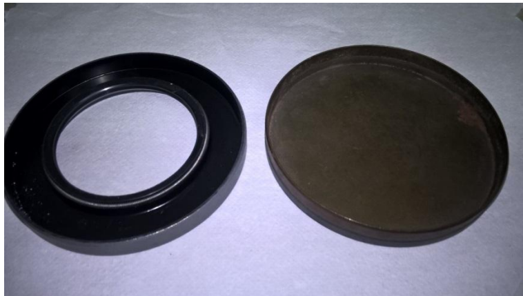
Figura 2 Alguns tipos de vedantes encontrados nos redutores da SEW Fonte: Autor
