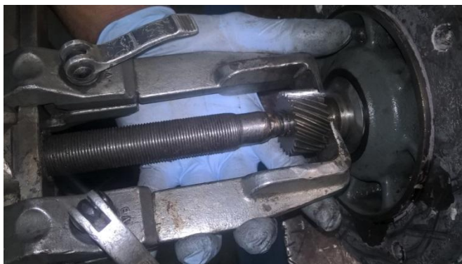
Figura 24 Utilizando sacador para remover engrenagem. Fonte: Autor
