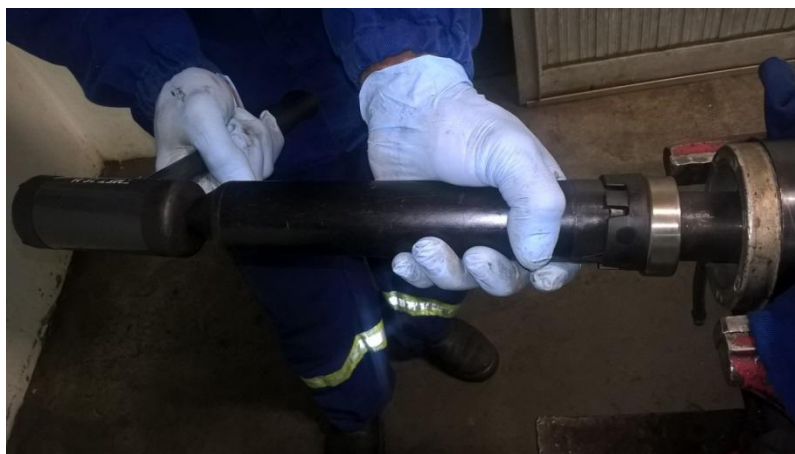
Figura 57 Utilizando o kit de montagem de rolamentos. Fonte: Autor
