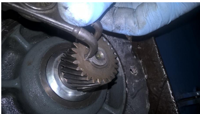
Figura 23 Retirando trava da coroa do motor. Fonte: Autor
