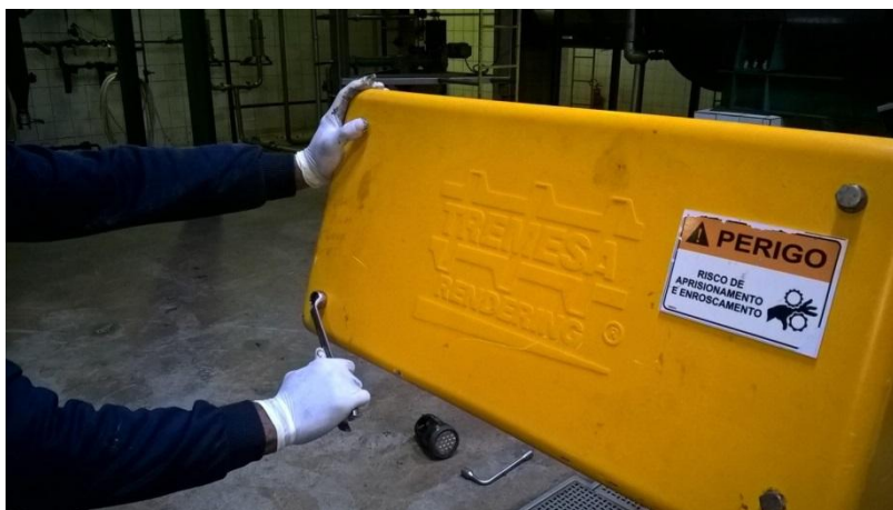
Figura 28 Retirando tampa de proteção da corrente e engrenagens.
