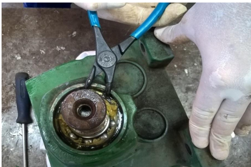
Figura 40 Retirando a trava do outra ponta do eixo maior. Fonte: Autor
