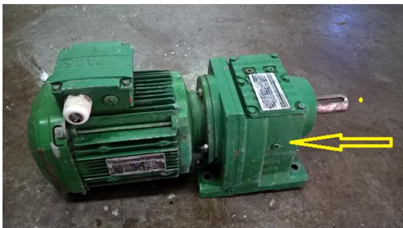
Figura 25 Indicação do local de verificação do nível do óleo. Fonte: Autor
