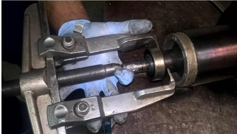
Figura 55 Utilizando sacador para remover os rolamentos. Fonte: Autor
