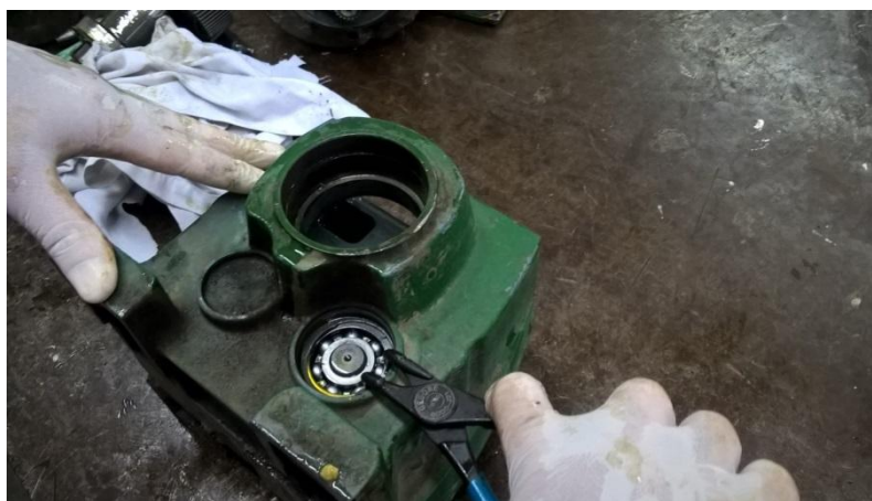
Figura 46 Removendo trava do eixo menor com alicate. Fonte: Autor
