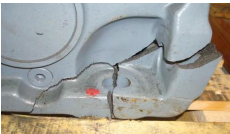
Figura 7 Carcaça do redutor quebrado por fadiga Fonte: Manual técnico redutores SEW
