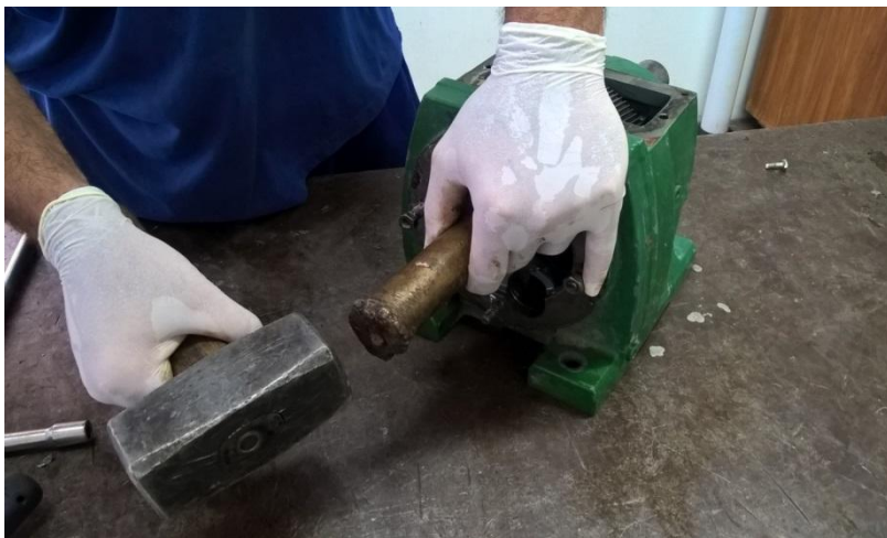
Figura 20 Utilizando marreta e o tarugo de cobre para remover eixo. Fonte: Autor
