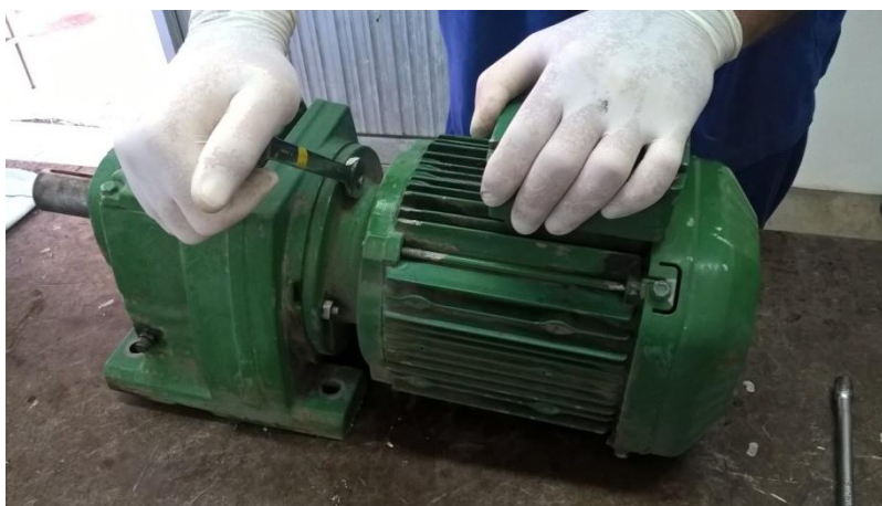
Figura 34 Retirando parafusos que une o motor e a caixa redutora. Fonte: Autor
