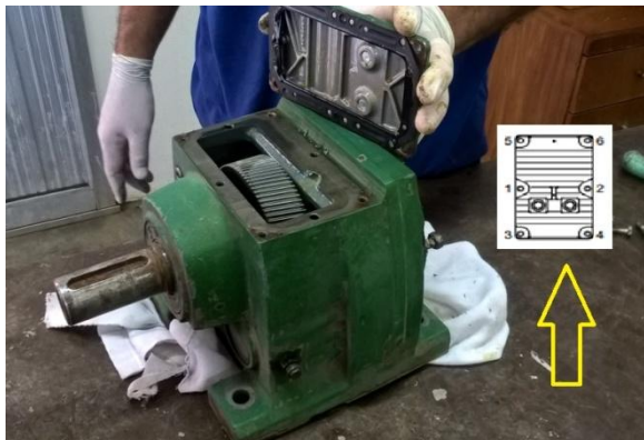
Figura 18 Retirando a tampa do redutor. Fonte: Autor
