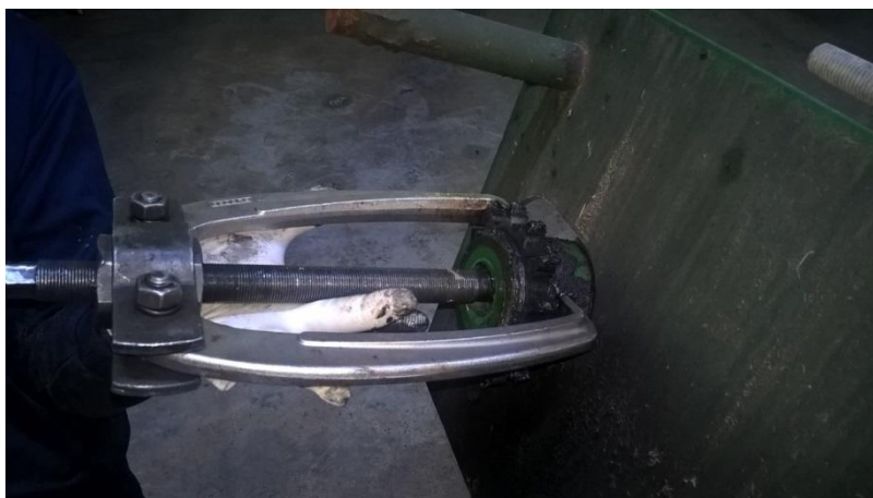
Figura 30 Retirando engrenagem do eixo do redutor. Fonte: Autor
