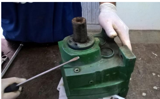
Figura 39 Retirando o retentor com a chave de fenda. Fonte: Autor
