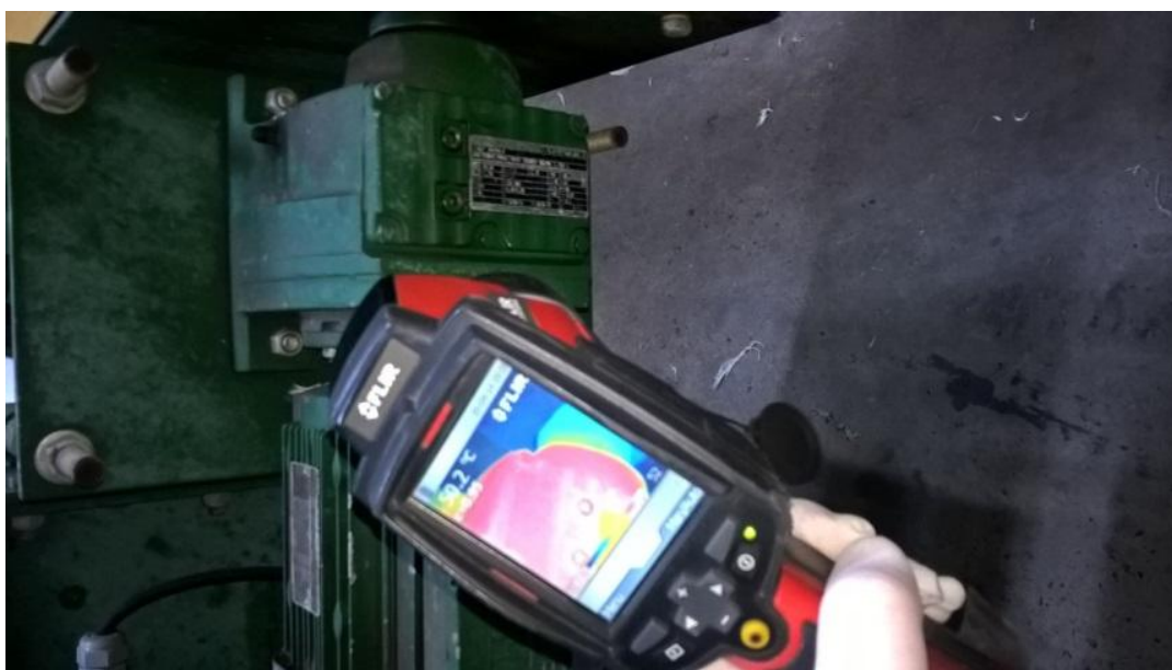
Figura 04 Termógrafo marca FLIR, medido a temperatura de trabalho do motorreductor Fonte: Autor
