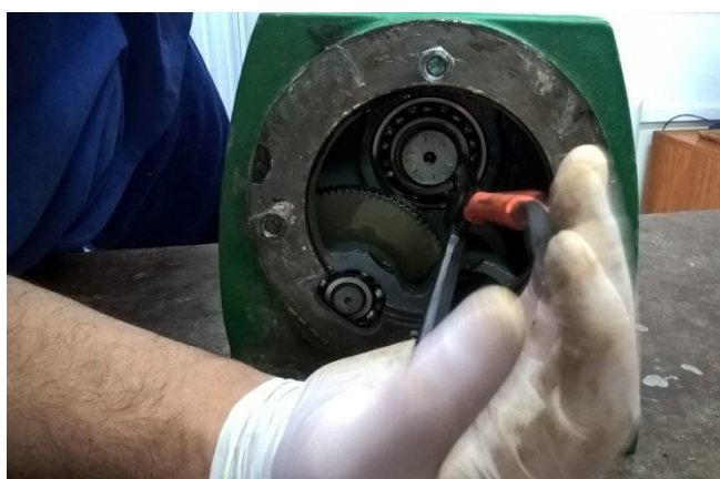
Figura 19 Retirando trava do eixo maior. Fonte: Autor
