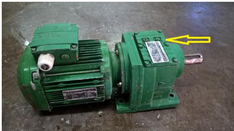
Figura 14 Indicação local usado para completar o nível de óleo. Fonte: Autor
