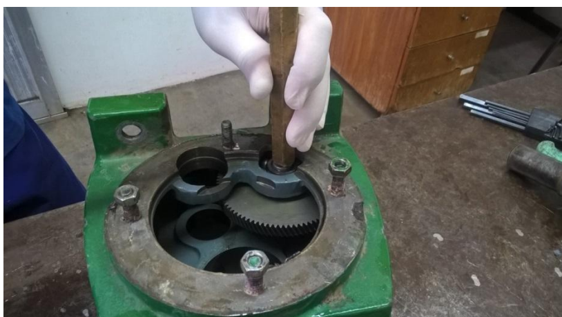
Figura 48 Utilizando um tarugo de cobre para remover eixo menor. Fonte: Autor
