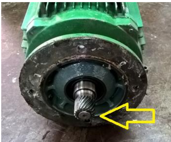
Figura 36 Coroa de acoplamento entre motor e redutor. Fonte: Autor
