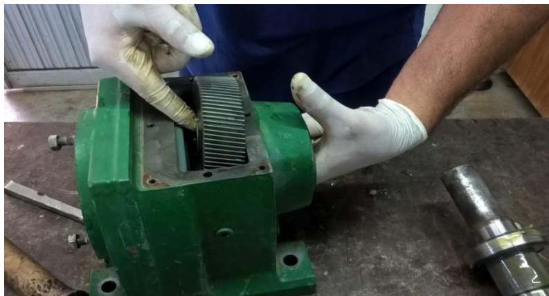
Figura 43 Retirando a engrenagem da caixa. Fonte: Autor
