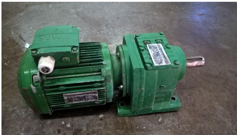
Figura 15 Motorreductor após limpeza do mesmo. Fonte: Autor
