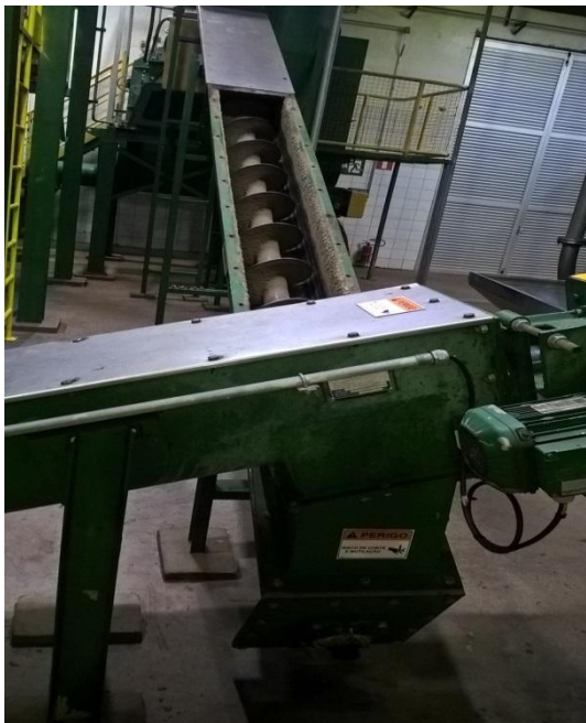
Figura 03- Detalhe do posicionamento do transportador helicoidal Fonte: Autor
