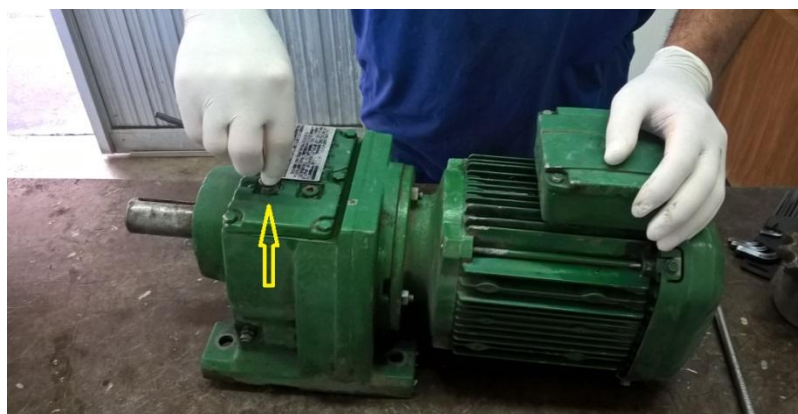
Figura 32 Retirando parafuso da tampa do redutor. Fonte: Autor
