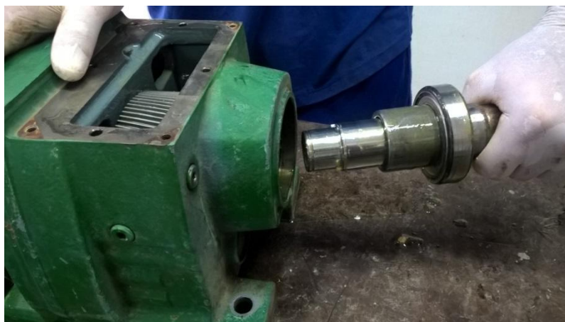
Figura 21 Removendo o eixo maior. Fonte: Autor
