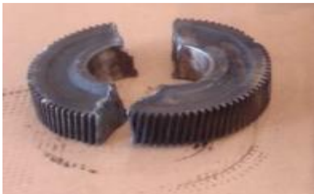
Figura 8 Engrenagem dividida por sobrecarga Fonte: Manual técnico redutores SEW
