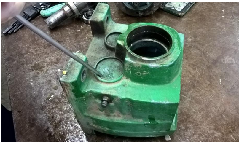
Figura 45 Removendo o tampão de vedação. Fonte: Autor
