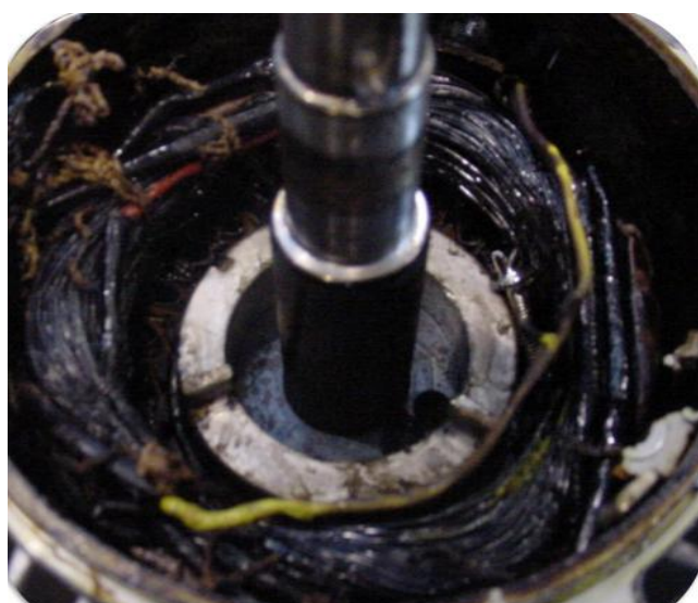
Figura 20 Dano por rotor do motor bloqueado Fonte: Manual técnico redutores SEW
