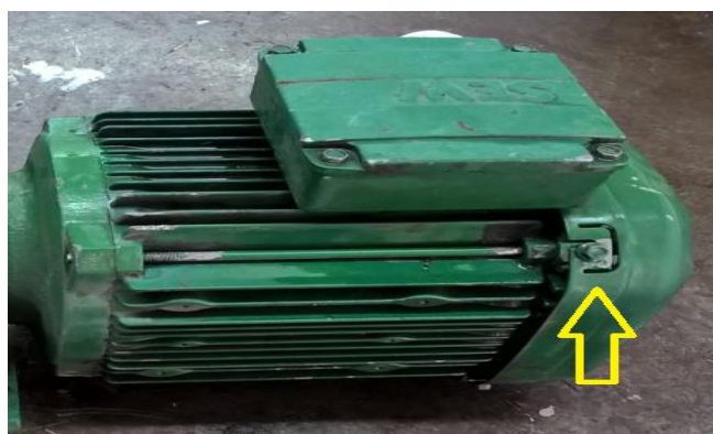
Figura 25 Indicação do local dos parafusos da proteção da ventoinha. Fonte: Autor
