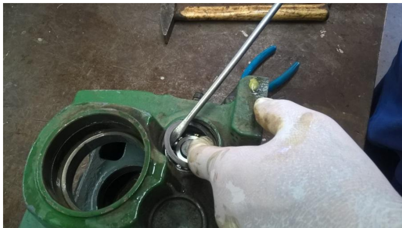
Figura 47 Utilizando uma chave de fenda para remover o anel. Fonte: Autor
