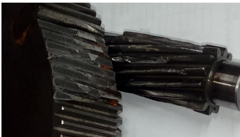
Figura 9 Quebra por travamento do conjugado Fonte: autor
