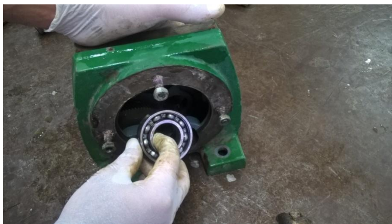
Figura 22 Retirando o rolamento da caixa. Fonte: Autor
