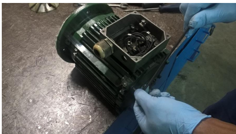
Figura 5427 Retirando tampa traseira da carcaça do motor. Fonte: Autor
