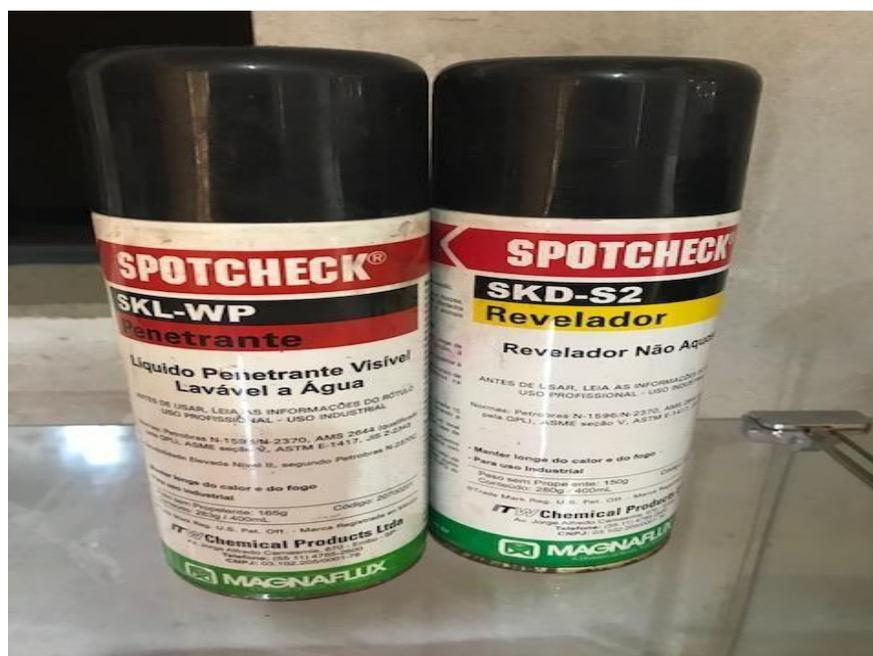
Figura 1: Spray utilizado para análise de falhas na solda.
