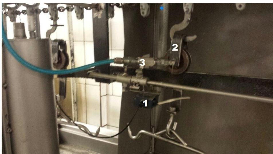
Figura 8: Local de instalação do sensor indutivo.
