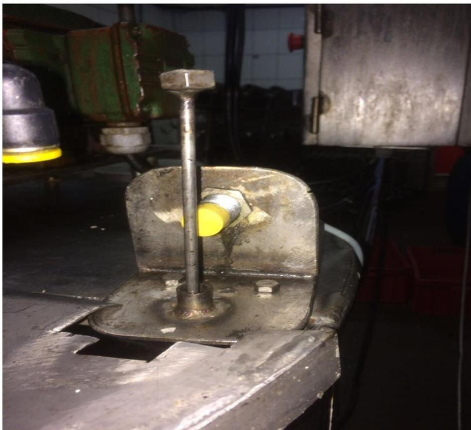
**Figura 4: Sensor indutivo e porca soldada na haste.**
