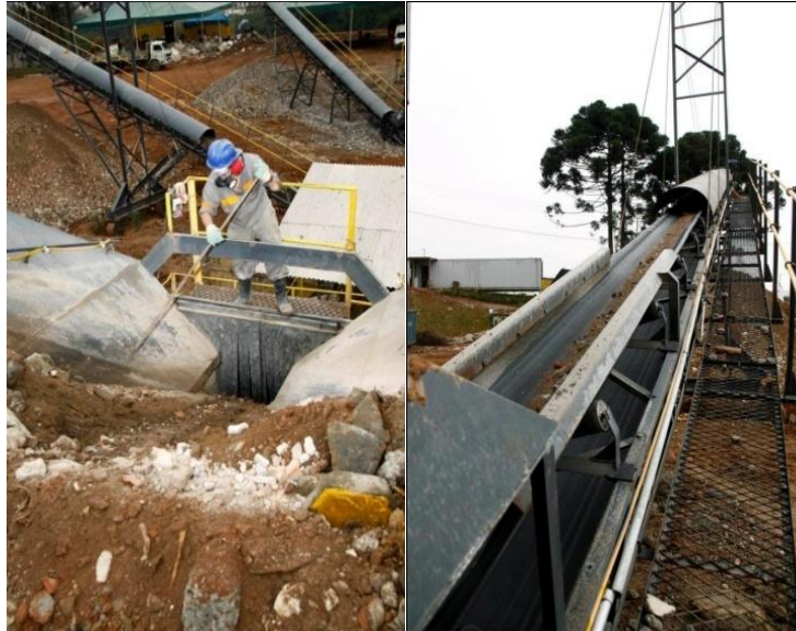
Figura 13 – Processo de britagem dos RCCR Fonte: USIPAR, 2013.
