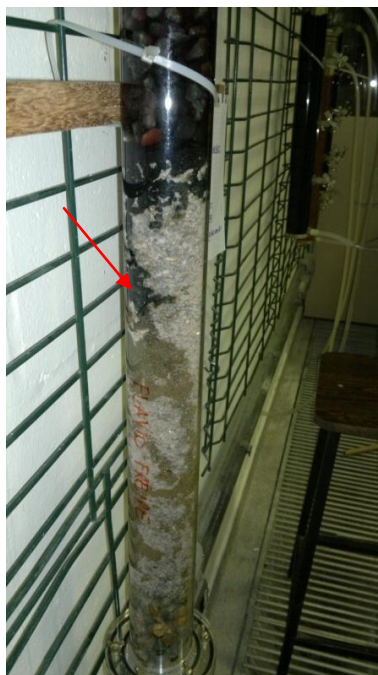
Figura 23 – Formação de caminhos preferenciais na coluna de adsorção com RCCR
