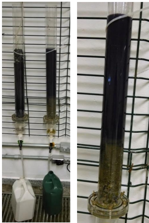
Figura 24 – Colmatação das colunas de adsorção em escoamento afogado.
