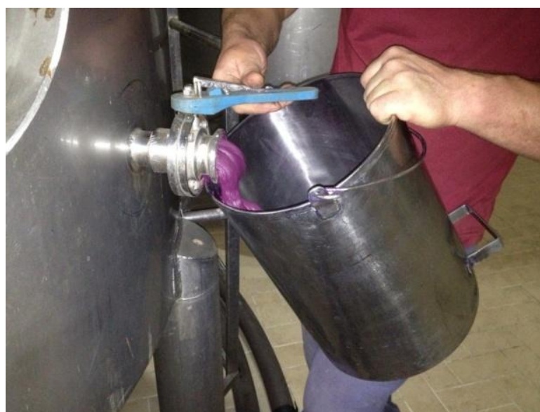
Figura 4 – Retirada da grúspula em um tanque de decantação
