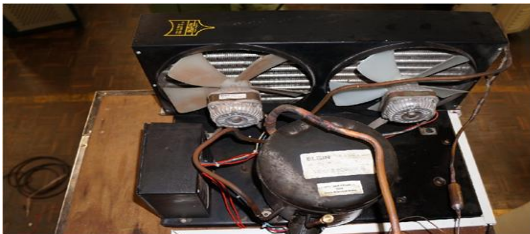
Figura 15 – Foto Compressor e Trocador de Calor
