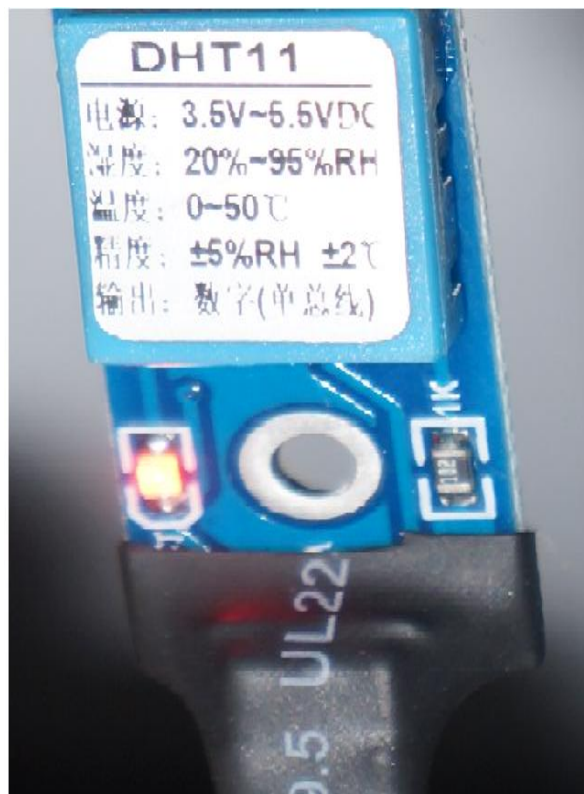
Figura 10 – Foto Sensor de Temperatura e umidade
