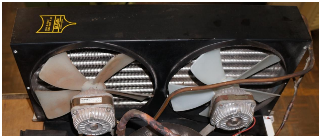
Figura 5 – Foto Trocador de calor
