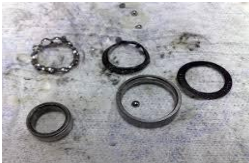
Figura 9- rolamento danificado Fonte: arquivo pessoal
