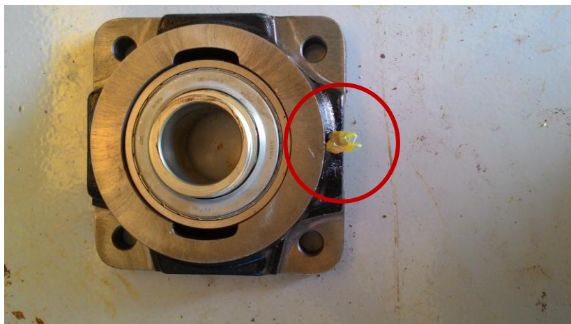
Figura 20 - detalhe implantação da graxeta de lubrificação Fonte: arquivo pessoal
