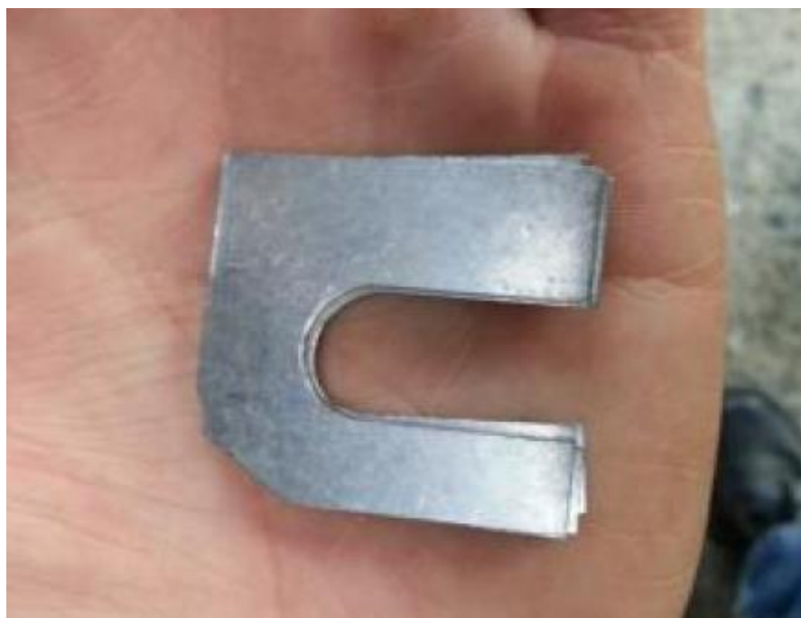
Figura 12- calços de afinação Fonte: arquivo pessoal
