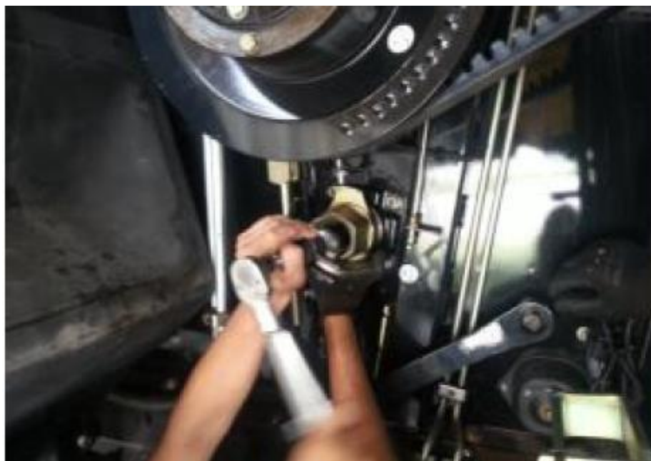
Figura 10- removendo porca de fixação Fonte: arquivo pessoal
