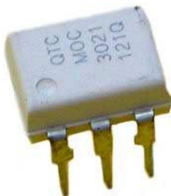
**Figura 12. Opto-acoplador MOC3021**
