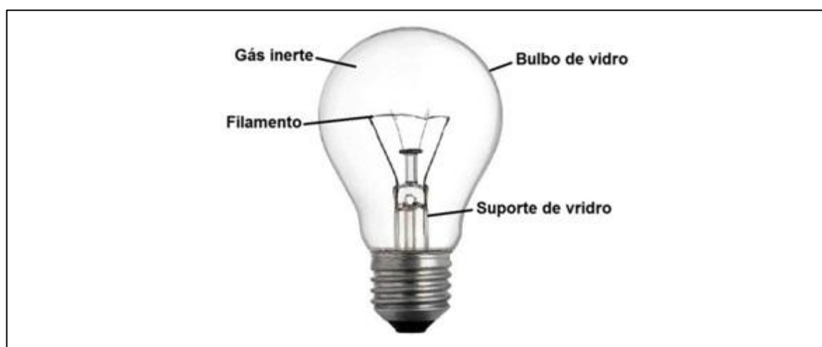
Figura 8: Lâmpada incandescente. Fonte: Elaborado pelo autor.
