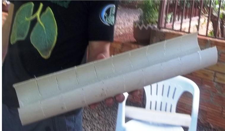
**Figura 2 – Colunas de PVC marcadas, seccionadas e parafinadas.**
