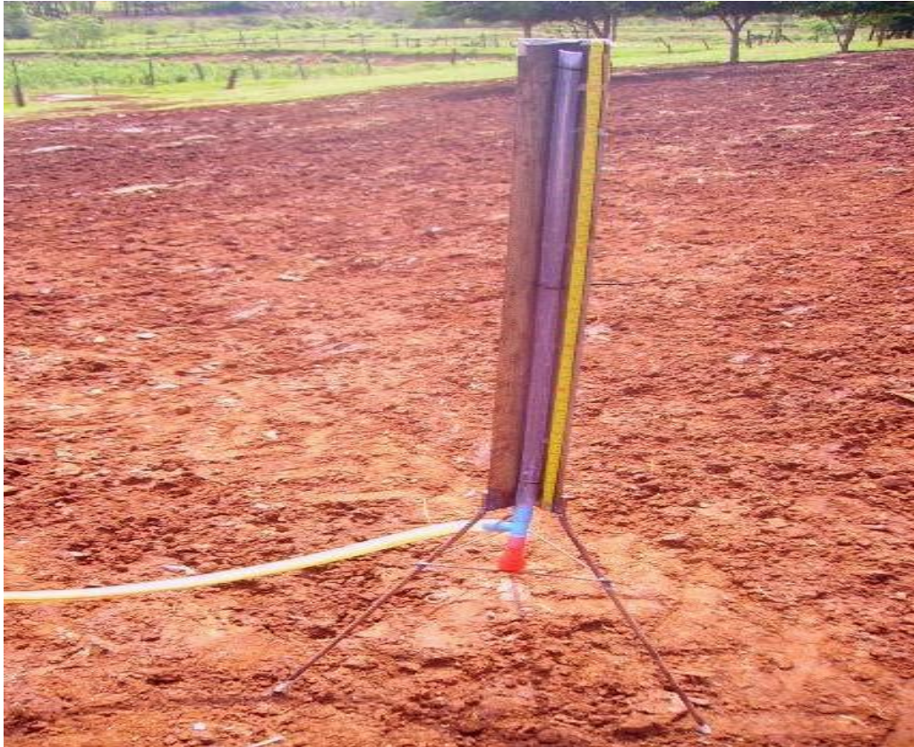
Figura 09 – Medidor Construído Para Determinar a Vazão de Biogás.
