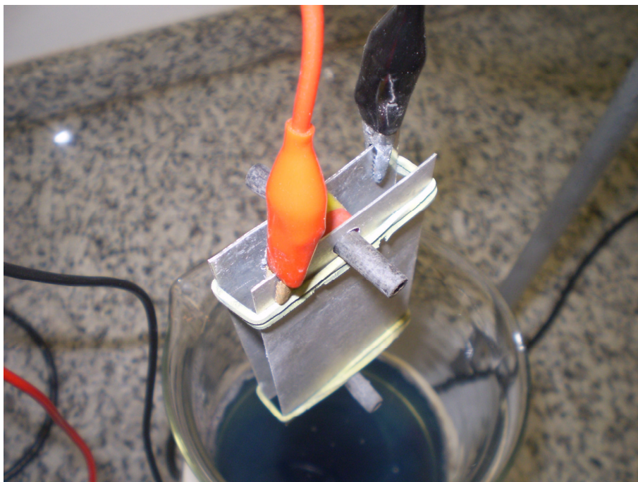
Figura 2 – Sistema da montagem dos eletrodos
