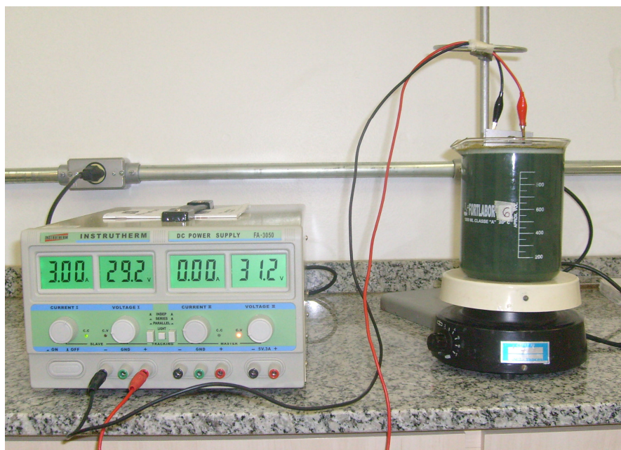
Figura 3 – Montagem experimental para realizar a eletrofloculação
