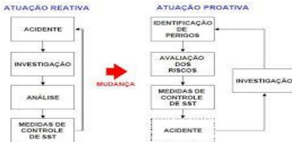
Figura 1. Mudança de forma de atuação reativa para proativa Fonte: Adaptado de Benite (2004).
