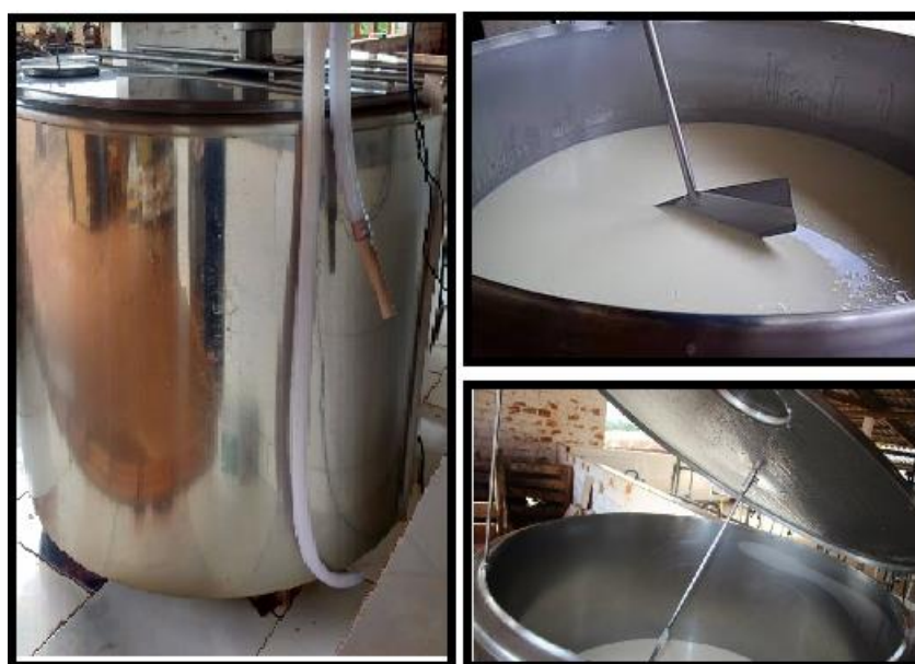
Figura 17 - Resfriador de leite Fonte: Autoria Própria (2017).
