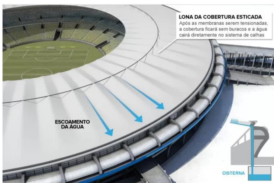
Figura 3 - Sistema de captação de águas pluviais do estádio Maracanã - RJ Fonte: Globo Esporte (2013).
