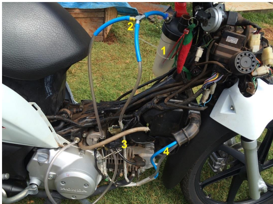
Figura 5 - Implementação do sistema vaporizador de combustível
