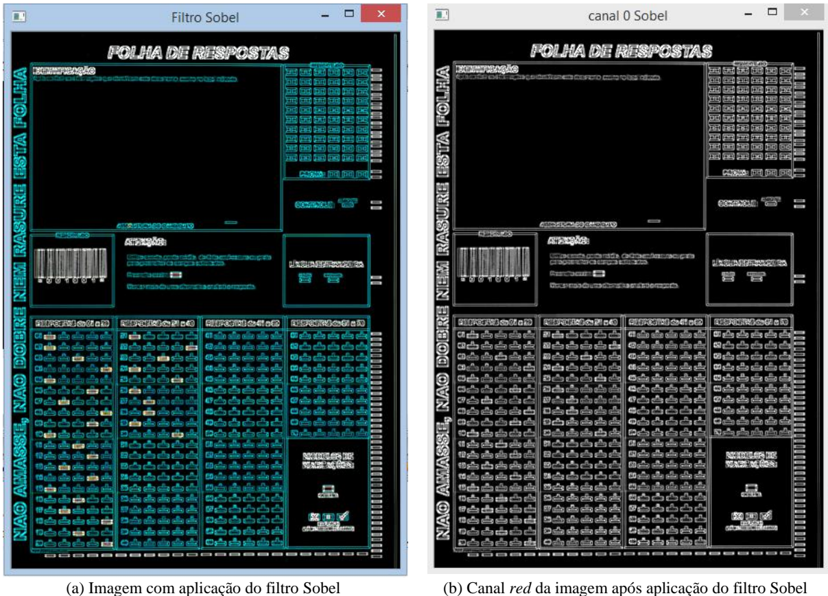
Figura 20 - Pré-processamento para aplicação do algoritmo Template Matching , que se tem (a) Imagem com aplicação do filtro Sobel e (b) Canal red da imagem após aplicação do filtro Sobel.
