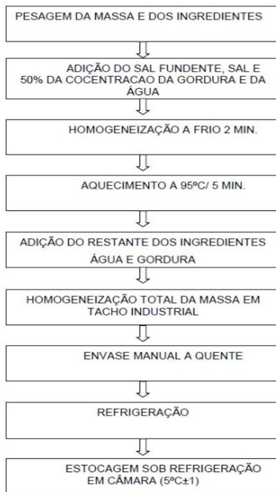
FIGURA 2: FLUXOGRAMA DA FUSÃO DA MASSA 2ª ETAPA
