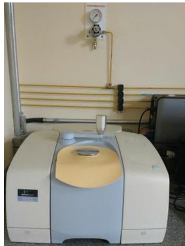
Figura 2 - Espectrômetro Infravermelho com Transformada de Fourier (FTIR).
