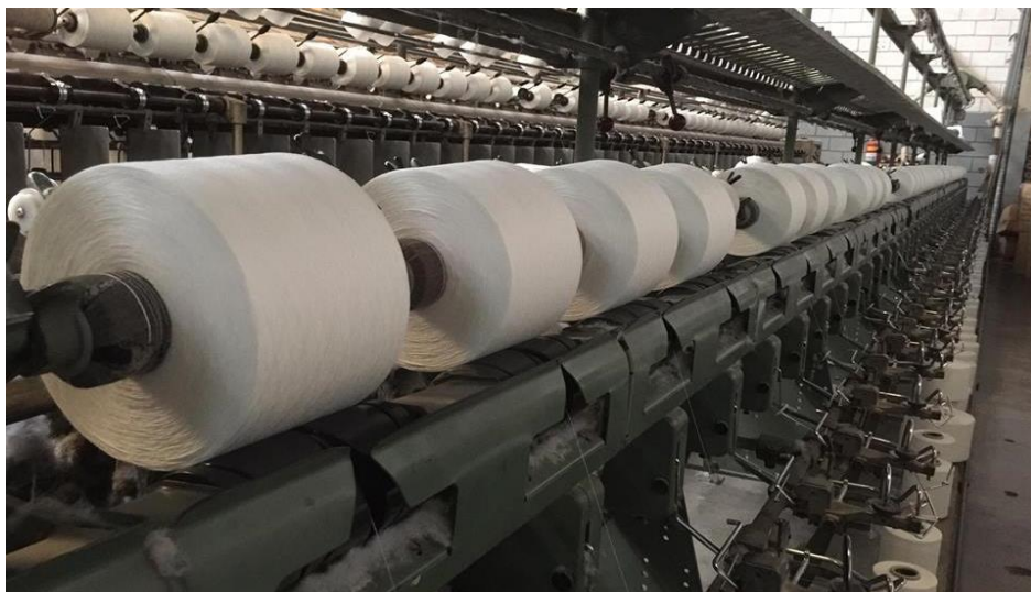
Figura 11 – Rocadeira em operação Fonte: Autores.
