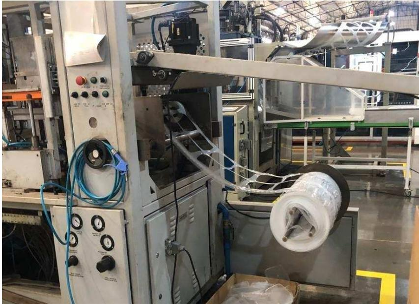
**Figura 17 - Geração de aparas no processo de formação**
