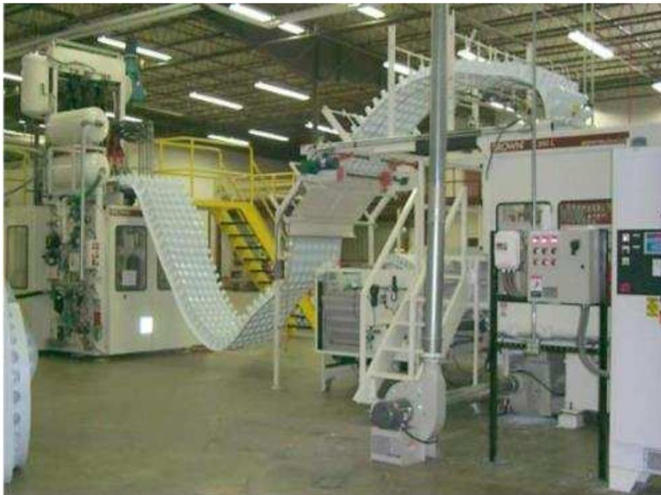
**Figura 6 - Máquina de termoformagem contínua**
