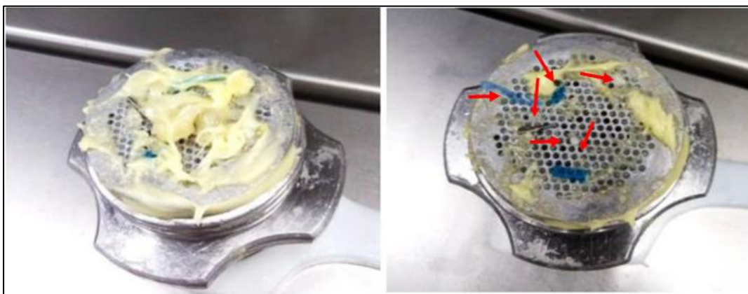
Figura 8 - Retenção dos Corpos de Prova no Filtro de Envase. Fonte: Autoria Própria (2019).
