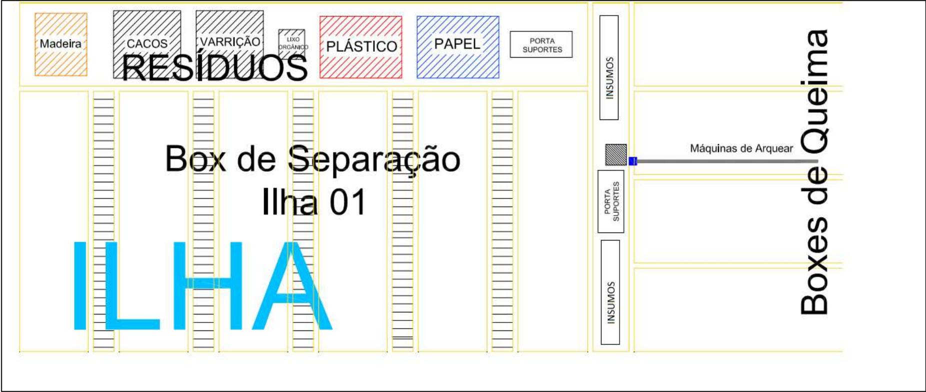
Figura 20: Arranjo físico da ilha de separação após brainstorming
