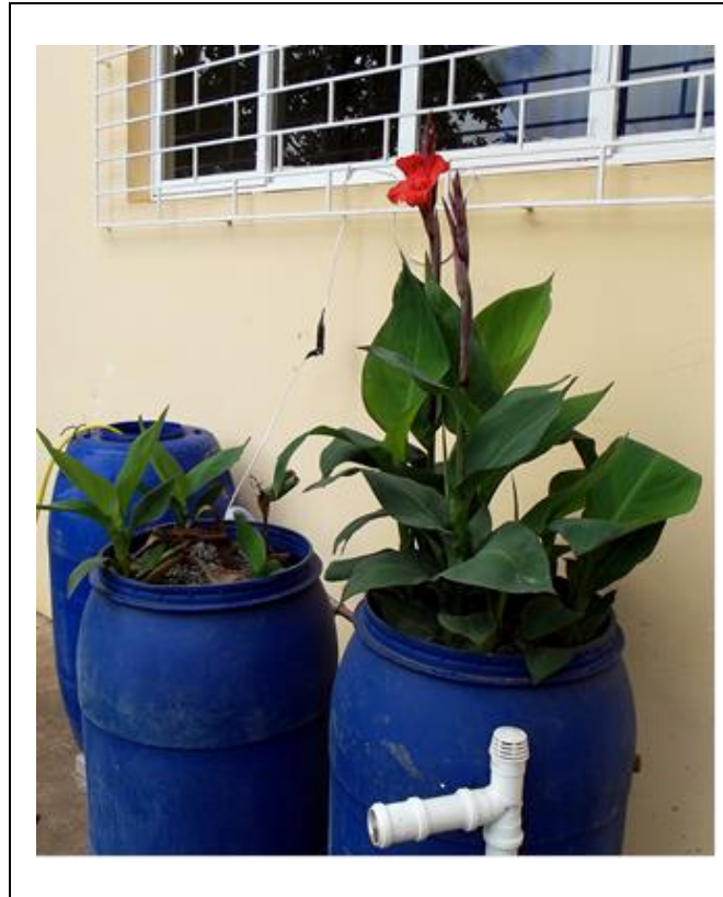
Figura 17. Vista frontal dos sistemas estudados na data de 23/11/2011, na esquerda o sistema de fluxo livre e a direita o sistema de fluxo afogado.
