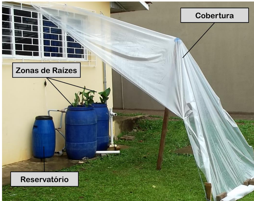
Figura 9: Vista geral do experimento, com atenção aos principais componentes: reservatório, zona de raízes e cobertura.
