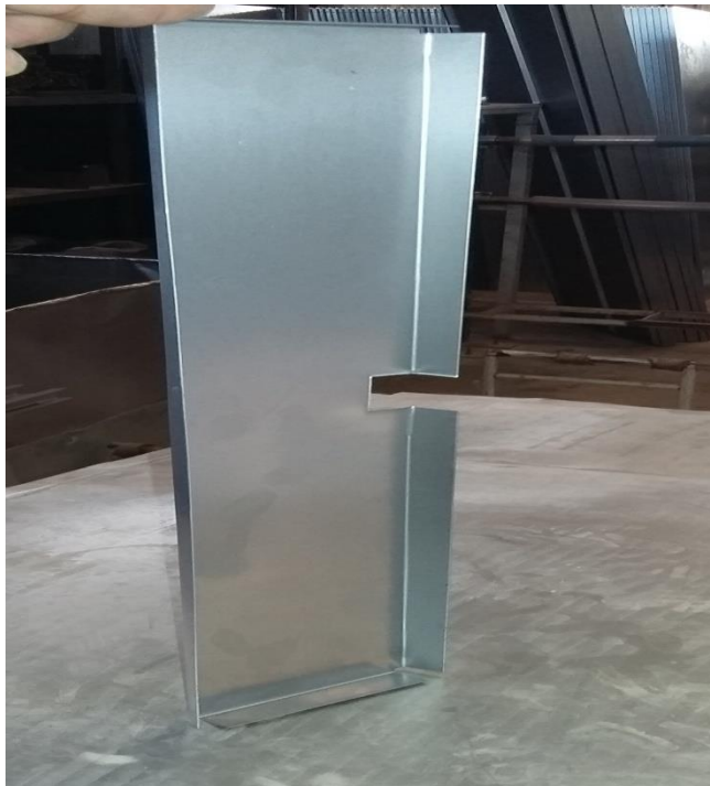
Figura 44: Reforço do Fundo do Arquivo de Aço. Fonte: O autor.
