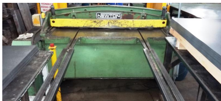
Figura 9: Guilhotina que executa o corte da largura. Fonte: O autor.
