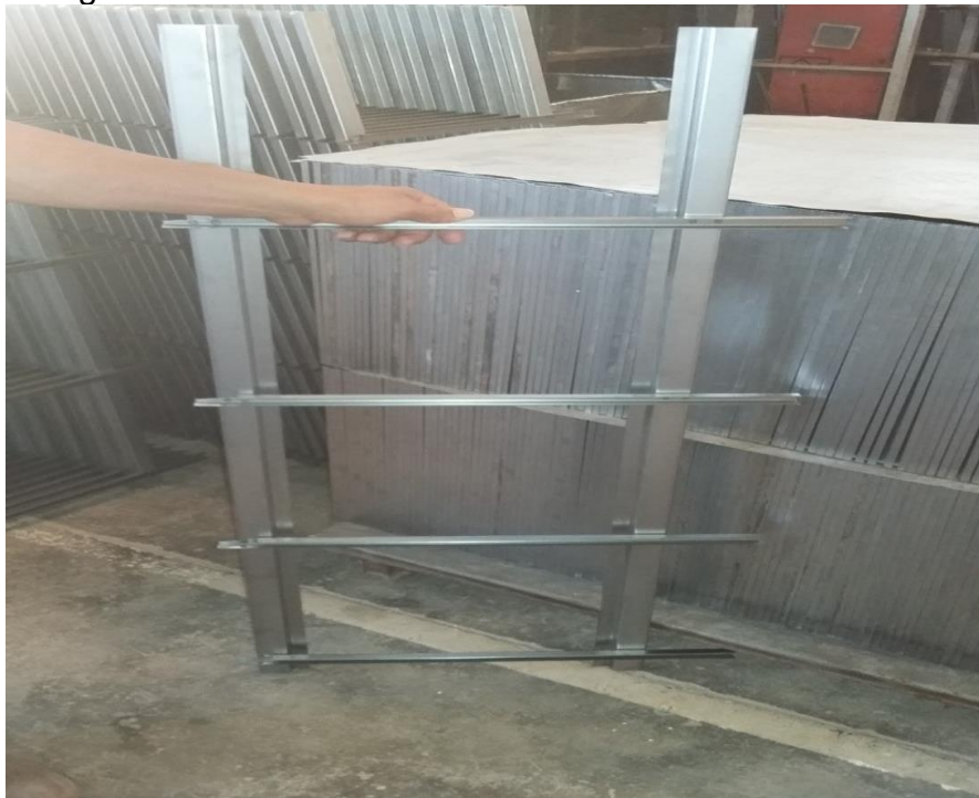
Figura 53: Montagem do cangalho completa. Fonte: O autor.
