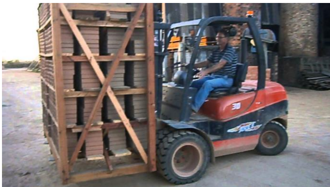
Figura 29. Transporte dos Blocos Cortados até a Estufa Fonte: Imagem Ilustrativa, retirada de um vídeo 2
