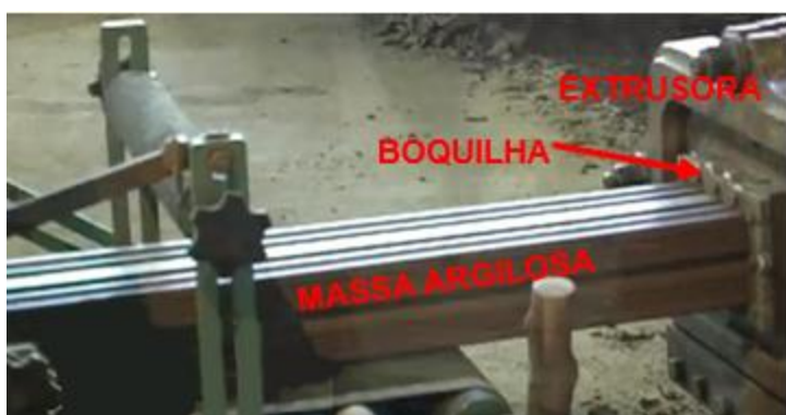
Figura 27. Argila Extrudada Fonte: Aatoria Própria (2016)
