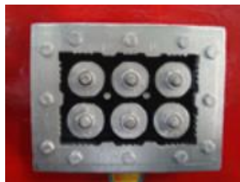
Figura 26. Boquilha de 9 cm x 14 cm com 6 Furos e Saída Única Fonte: BOQCER (2016)
