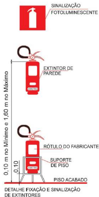
Figura 5 - Exemplo de sinalização de extintores
