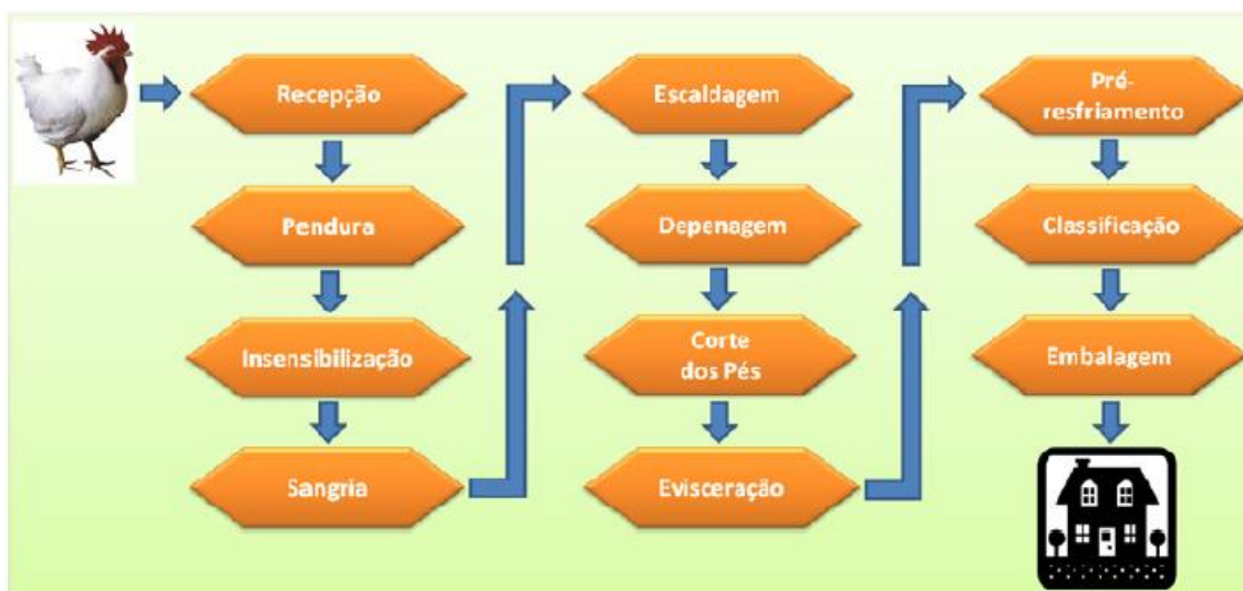
Figura 1 - Fluxograma do processo de abate de aves Fonte: PONTES (2009).
