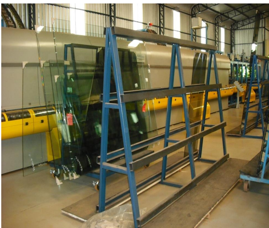
Figura 17 - Cavaletes para transporte dos vidros durante o processo Fonte: a autora (2013)
