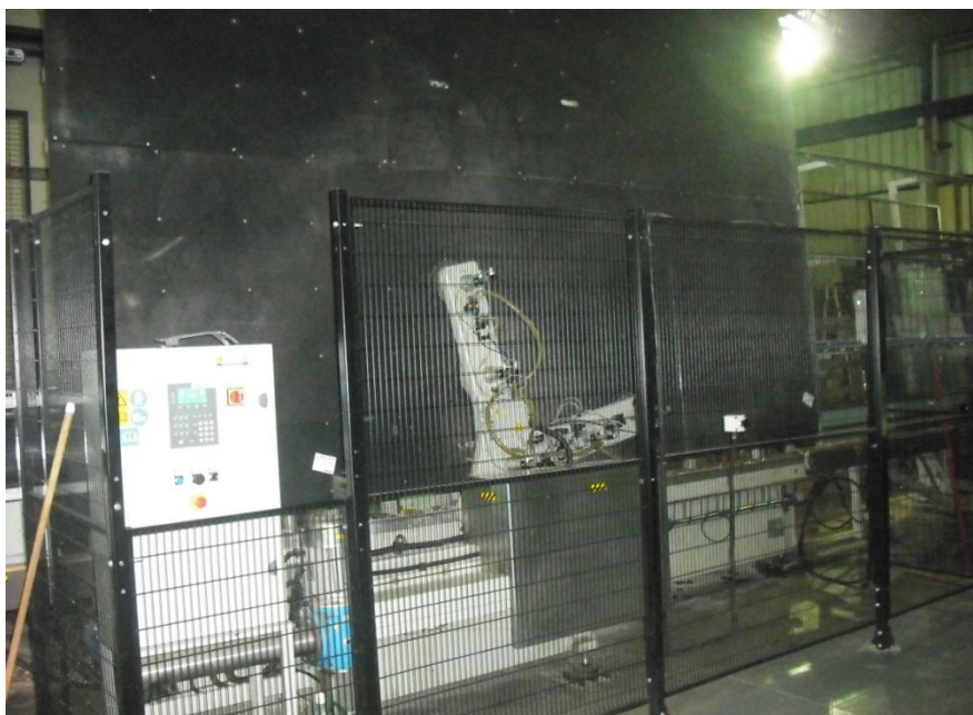
Figura 9 – Lapidadora de vidros Fonte: a autora (2013).
