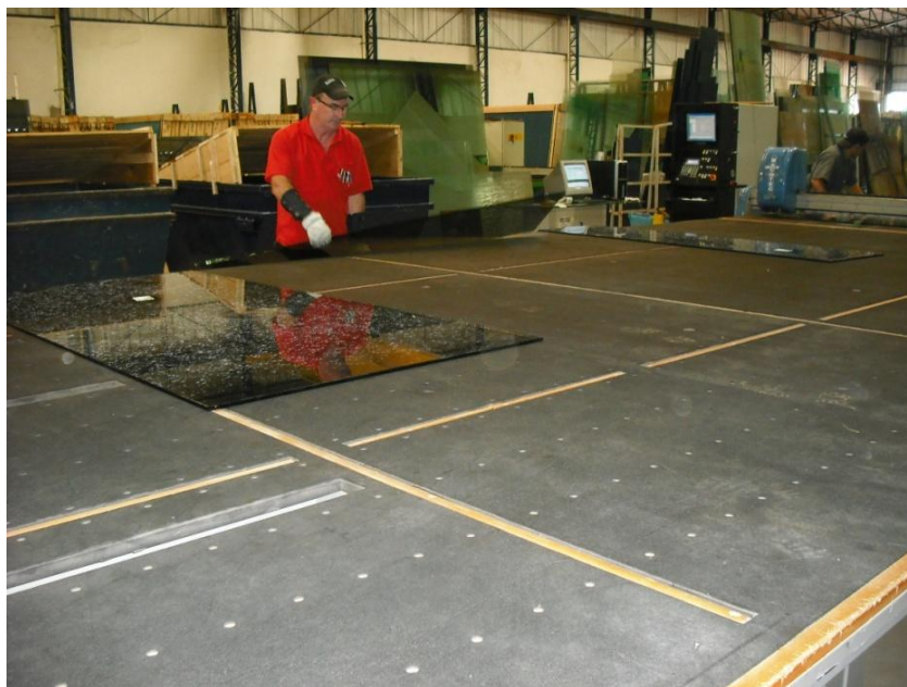
Figura 7 – Operador realizando a etiquetagem das peças cortadas Fonte: a autora (2013)
