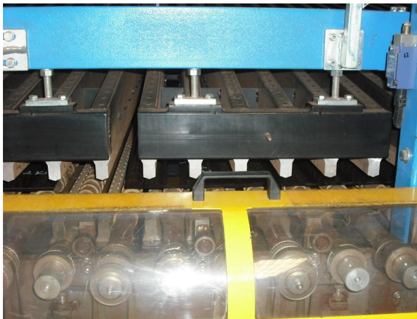
Figura 16 - Vidro recebendo o choque térmico com ar ambiente Fonte: a autora (2013)
