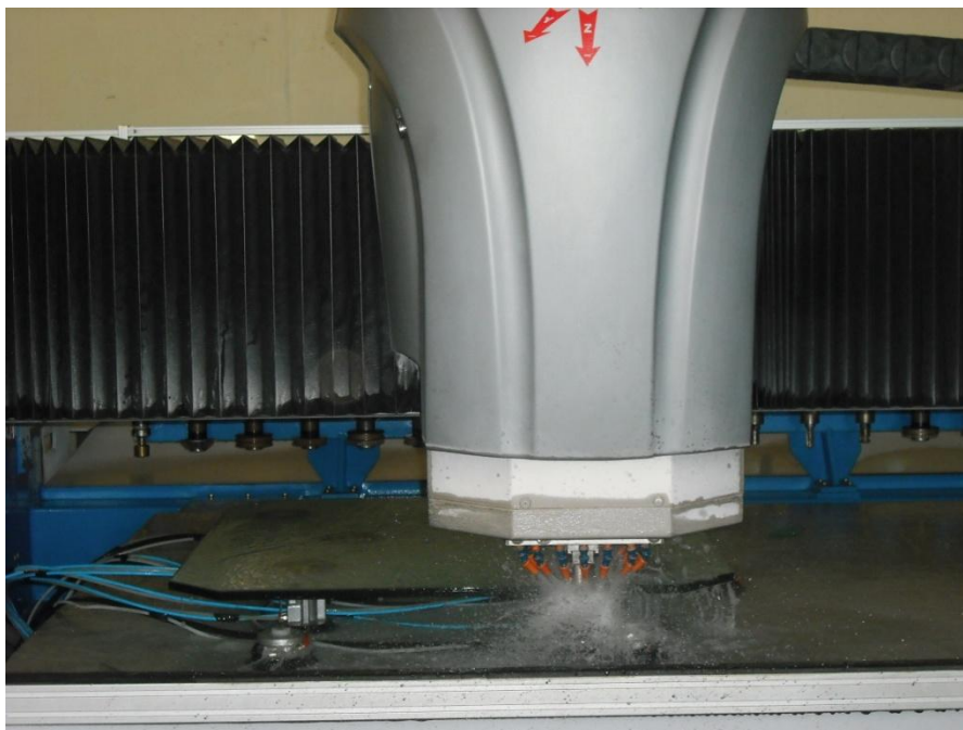
Figura 11 – Lapidação no centro de usinagem Fonte: a autora (2013).
