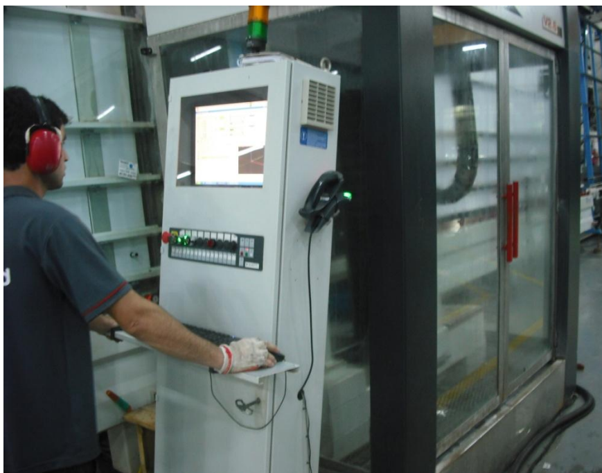
Figura 12 – Operador realizando a programação dos furos na furadeira Fonte: a autora (2013).
