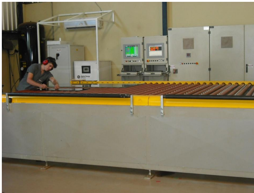
Figura 14 – Operador realizando a retirada das etiquetas na entrada do forno. Fonte: a autora (2013).
