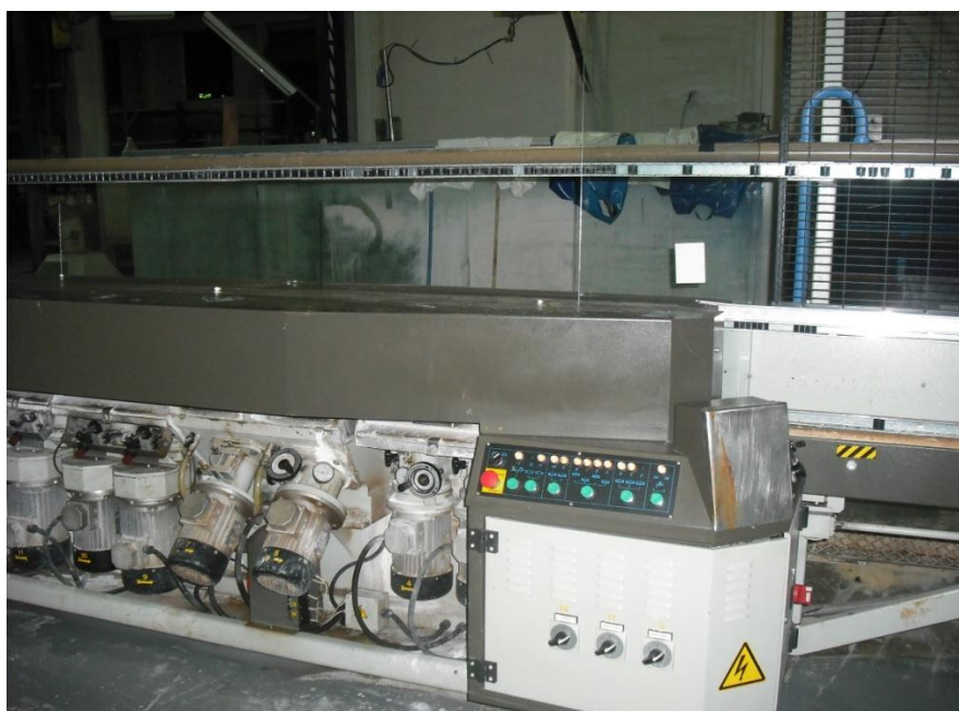
Figura 10 – Vidro incolor sendo lapidado Fonte: a autora (2013).
