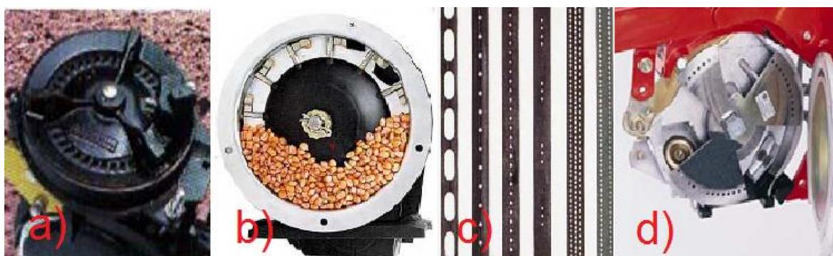
Figura 4 – a) Disco dosador; b) Dedos prensadores; c) Correia perfurada; d) Dosador pneumático
