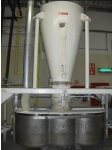
Figura 13 - Silo de descarga dos produtos Fonte: Aatoria própria.
