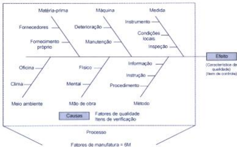
Figura 8 - Estrutura básica de um diagrama de causa e efeito Fonte: Campos (2014).
