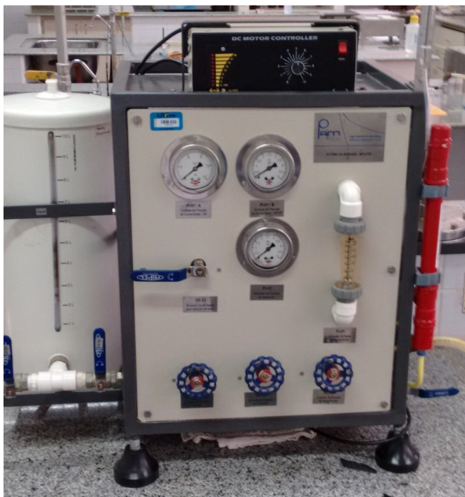
Figura 8 - Foto do sistema de bancada de micro e ultrafiltração
