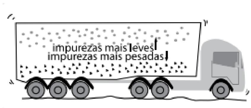
**Figura 8 – Imagem ilustrativa de um caminhão transportador de Grãos contendo a explicação visual da segregação das impurezas durante o transporte das cargas**
