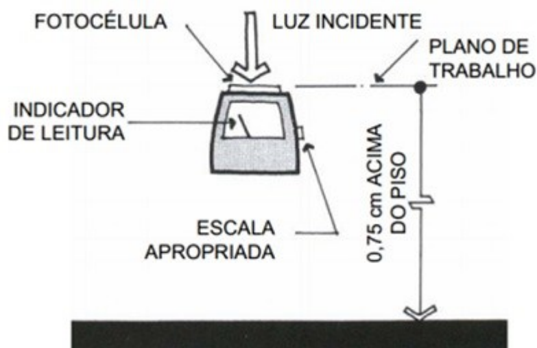
Figura 8: Medição com luxímetro Fonte: COMO, 2006.
