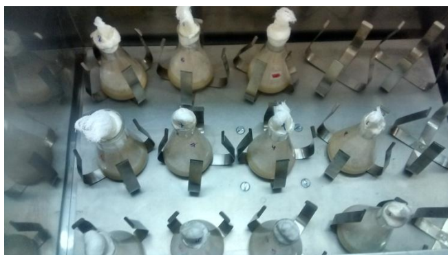
Figura 9 – Ensaios incubados em shaker para realização da fermentação alcoólica
