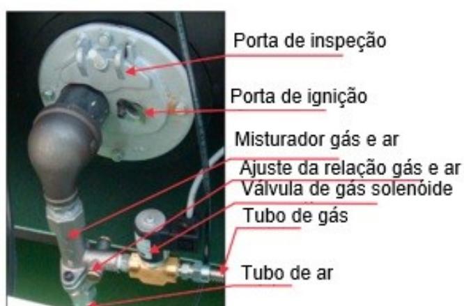
Figura 9. Queimador com regulação estequiométrica.
