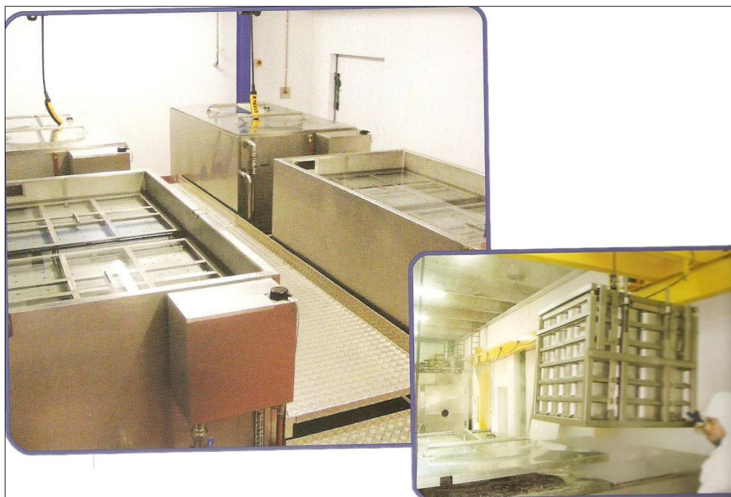
Figura 6. Tanques de resfriamento. Fonte: CREMINOX.
